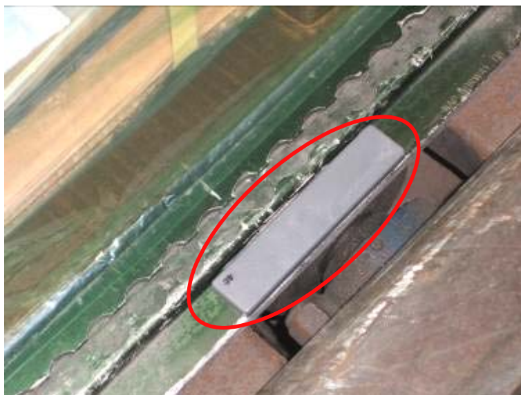
圖 7.7 貨盤貼附 RFID 抗金屬標籤示意圖
