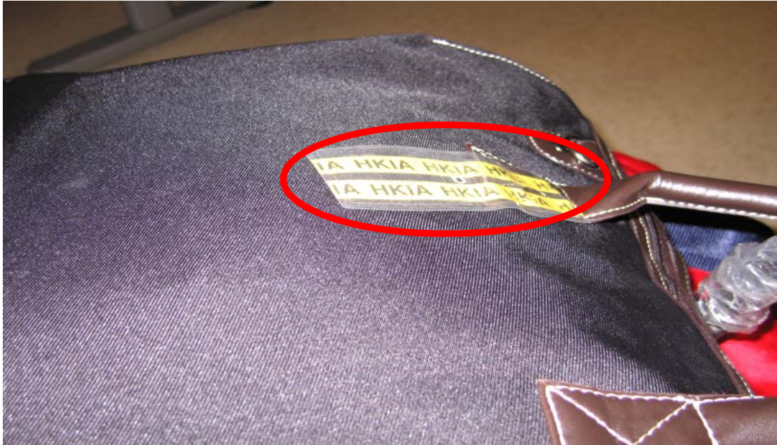
圖 3.8 香港機場託運行李的 RFID 電子標籤
