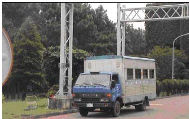
圖 3.13 測試車道 RFID 讀取器與測試車輛 RFID Tag 安裝圖
