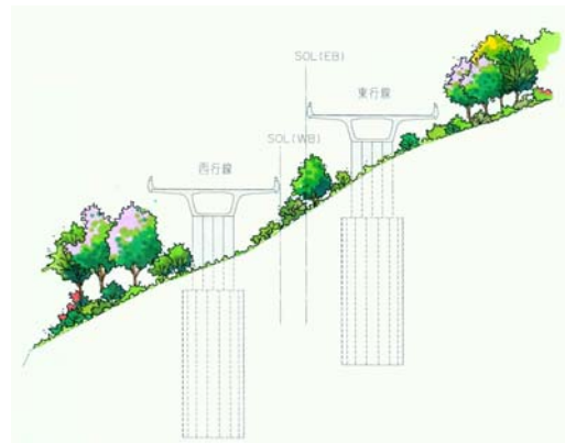
圖 5.2-2 國六南投段採高低縱面橋梁型式以減少環境衝擊 (資料來源：張瑞雄，2006)
