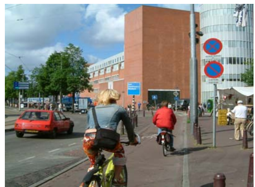
圖 5.6-5 設置在車道上之腳踏車道型式
