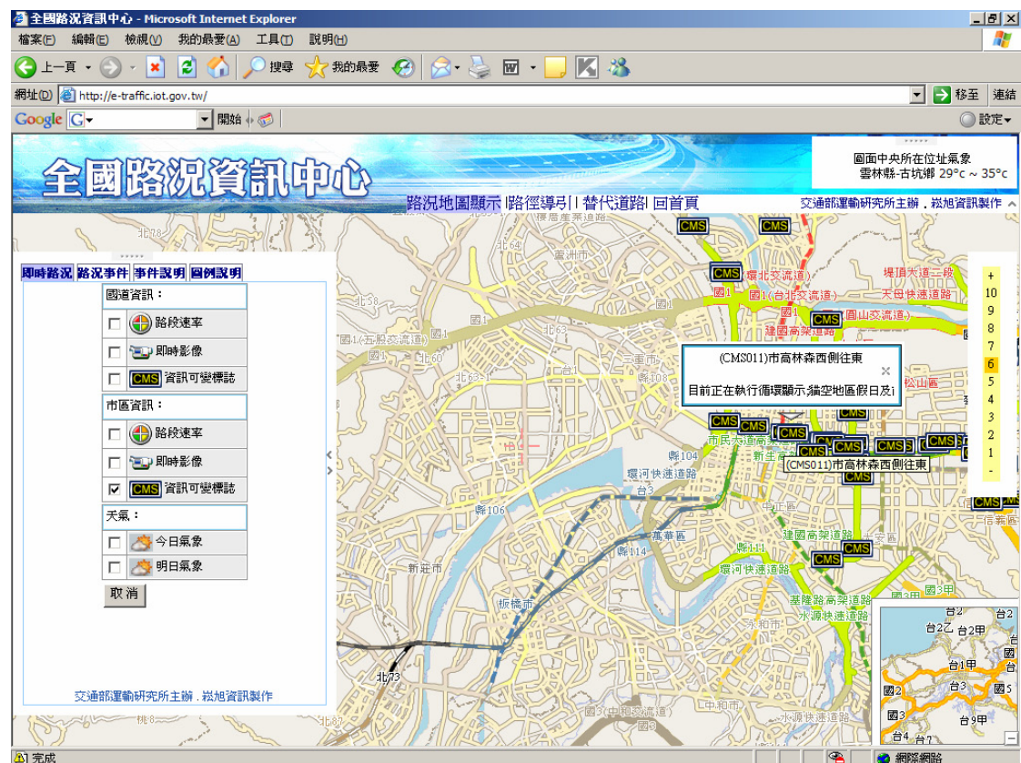
圖 5.2-18 點選市區 CMS 圖示顯示資訊可變標誌內容畫面
