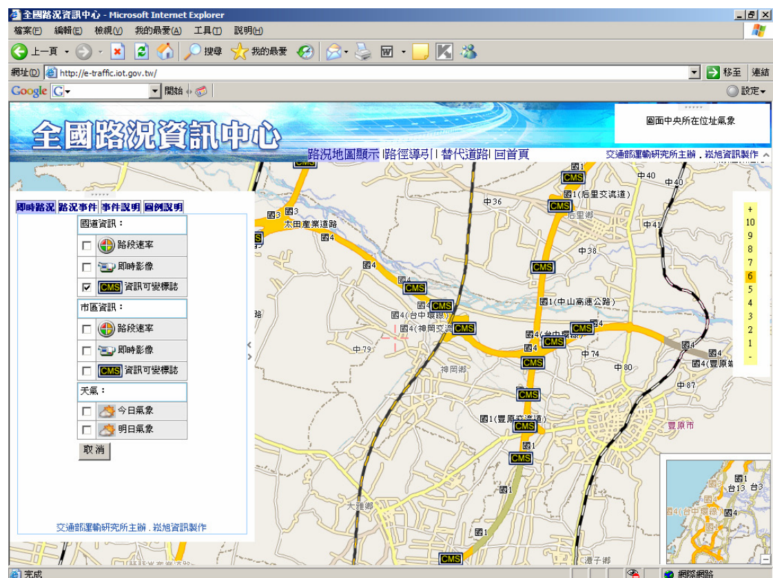
圖 5.2-9 資訊可變標誌於圖層 6 以上時顯示路線之 CMS 位置畫面
