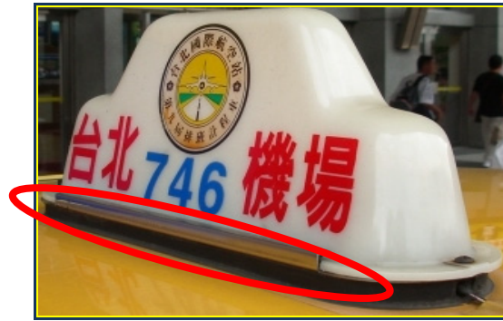
圖 4-19 螺絲鎖住及配合金屬拉帶固定型式車頂燈
