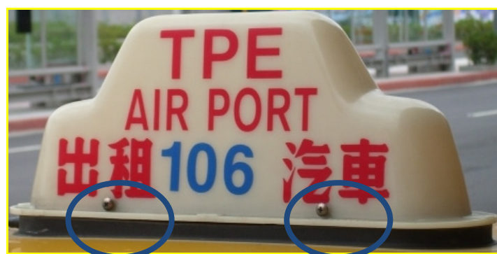
圖 4-18 螺絲直接鎖住固定型式車頂燈
