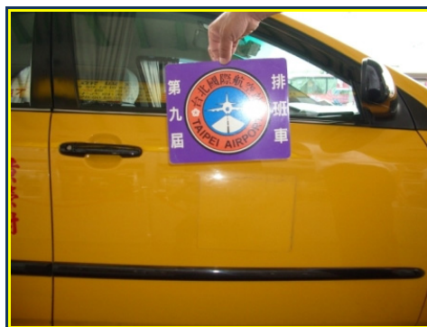
圖 4-20 軟質磁性貼片標識可輕易卸下
