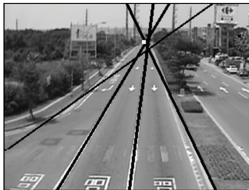
圖 3.1.3-5 車道線偵測並驗證後的結果
