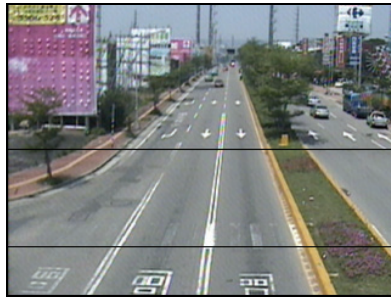
圖 3.1.3-1 車道線偵測區域示意圖
