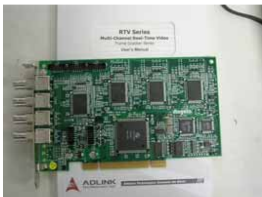
圖 4.2.2-5ADLink - RTV24 高速影像擷取卡
