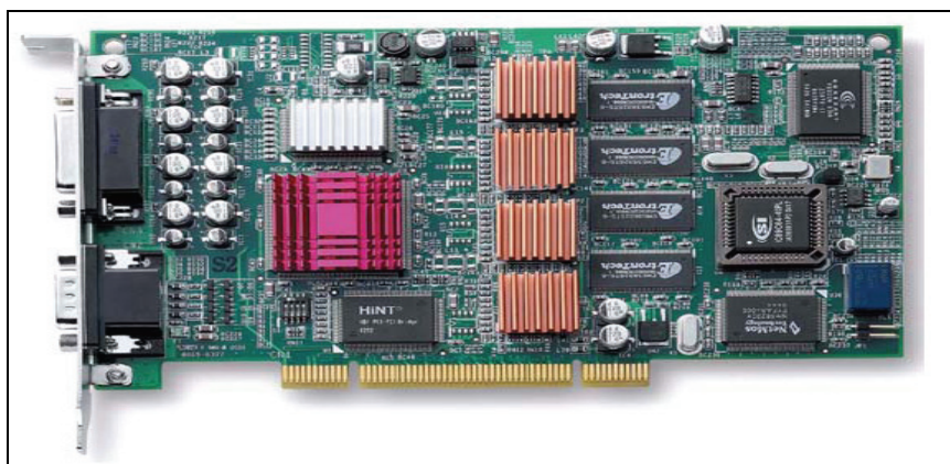
圖 3.3.2-1 PCI-MPG24 硬體影像壓縮卡
