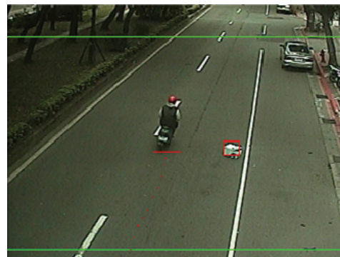
(b)掉落物偵測結果原始影像
