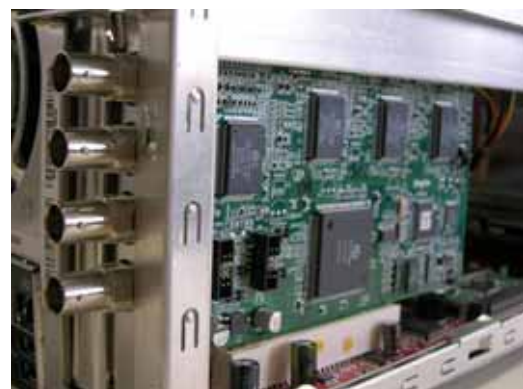
圖 4.2.2-5ADLink - RTV24 高速影像擷取卡
