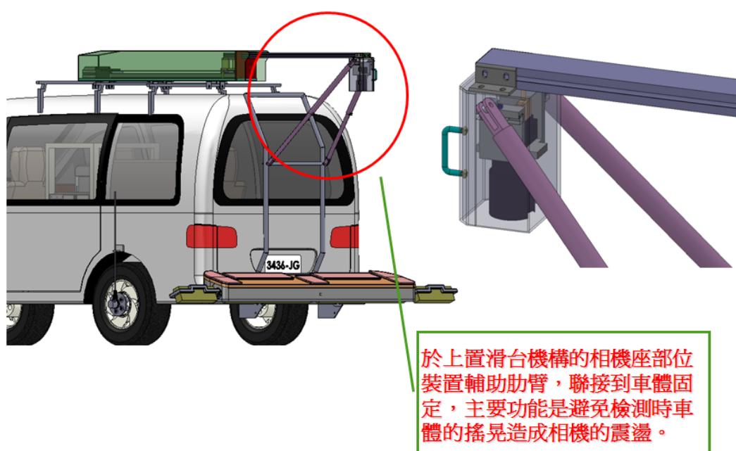
圖 6.14 線性滑軌與螺桿定位示意圖
