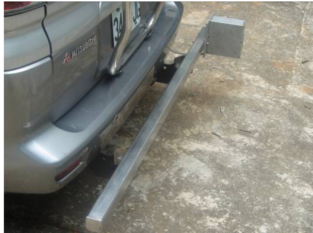
圖 6.2 智慧型檢測車 LED 光源模組放置處
