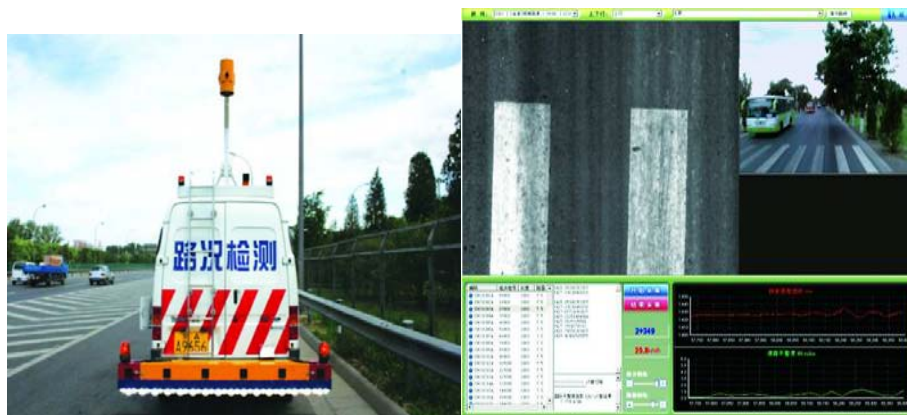
圖 2.11 鋪面影像檢測系統
