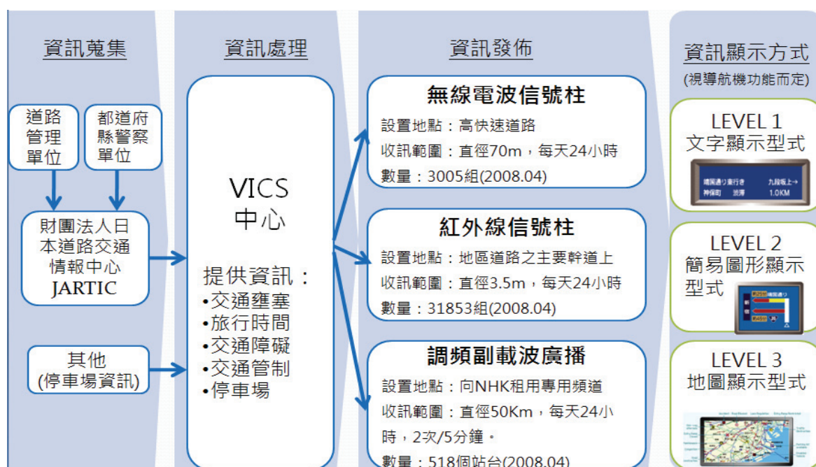
圖 2.3.3-3 VICS 系統服務架構
