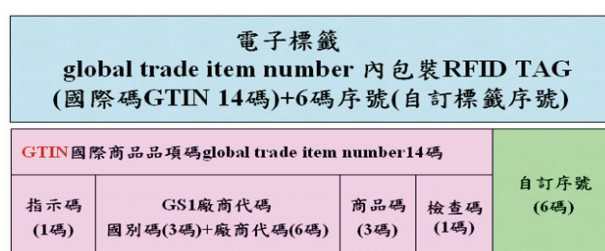
圖 3.5-2 貨箱 RFID 電子標籤(GTIN)資料結構
