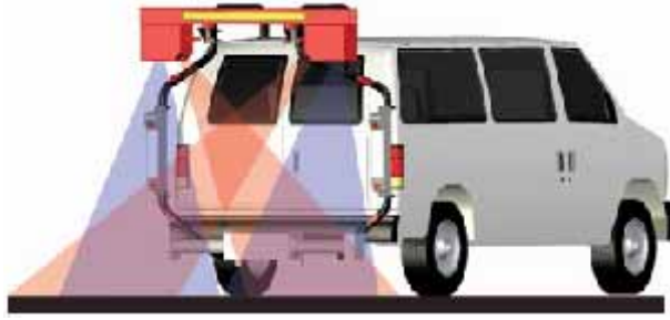
圖 2.18 Mandli鋪面影像擷取系統功能示意圖
