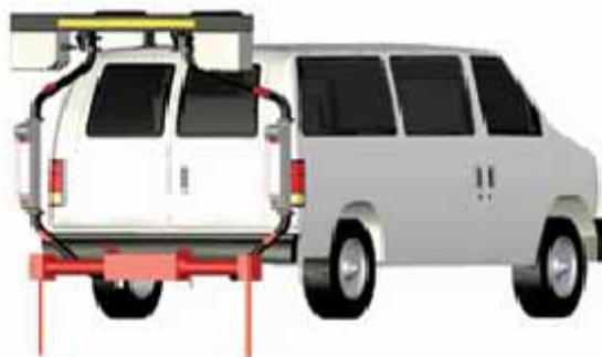
圖 2.20 Mandli鋪面平坦度檢測示意圖
