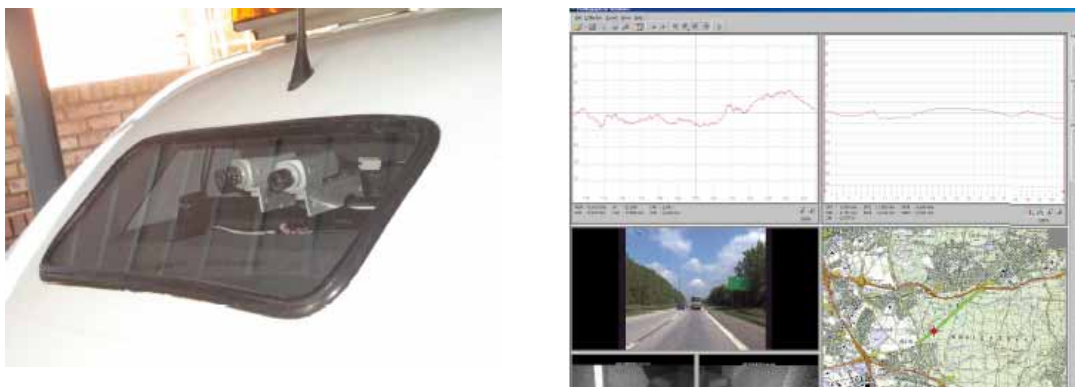
圖 2.23 Profilograph路權攝影示意圖
