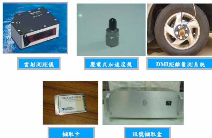
圖3.18 中央大學平坦度量測系統設備組成
