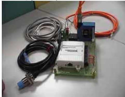
圖 3.12 平坦度量測儀器內部構造
