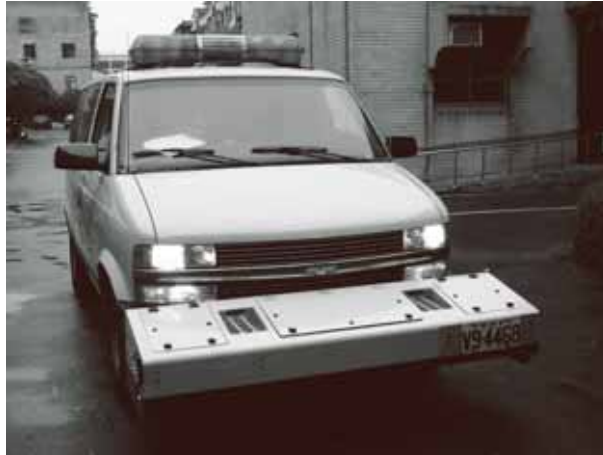
圖3.15 公路總局雙輪軌跡雷射縱向平坦度與橫向車轍檢測系統
