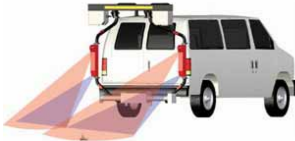
圖 2.19 Mandli雷射車轍量測系統功能示意圖
