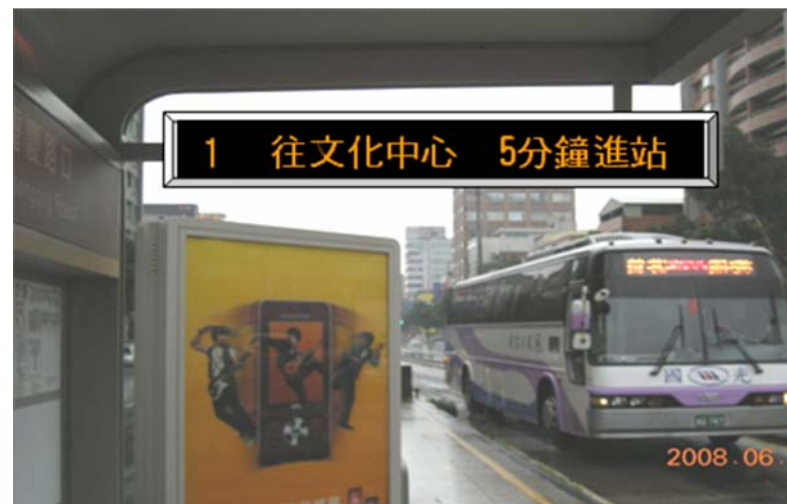
附圖 4 站牌顯示系統顯示公車即時資訊
