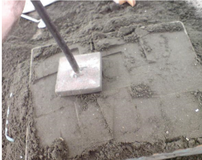
圖 4.16 鑄造砂模製作方式-以平頭鉗實
