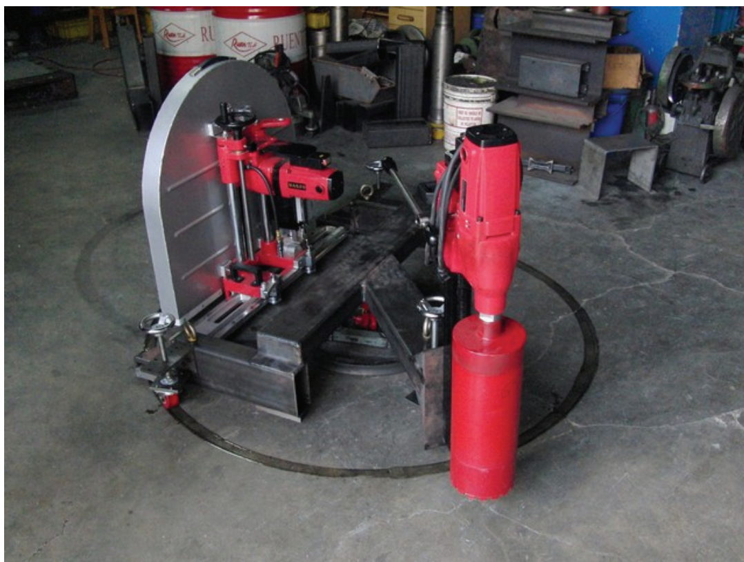
圖 4.33 小面積鋪面挖掘修補機具旋轉之情形
