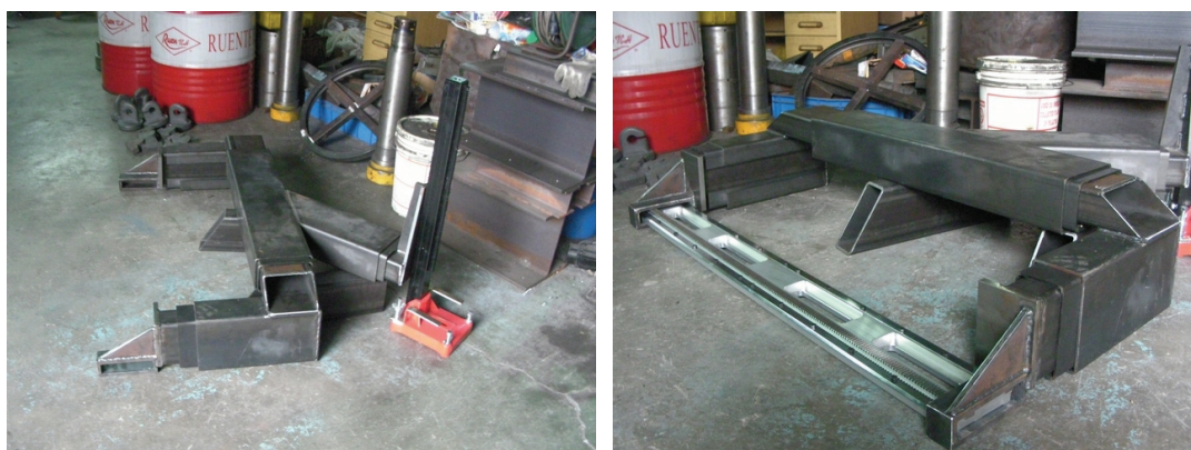
圖 4.22 預留安裝切割機運行軌道之機構
