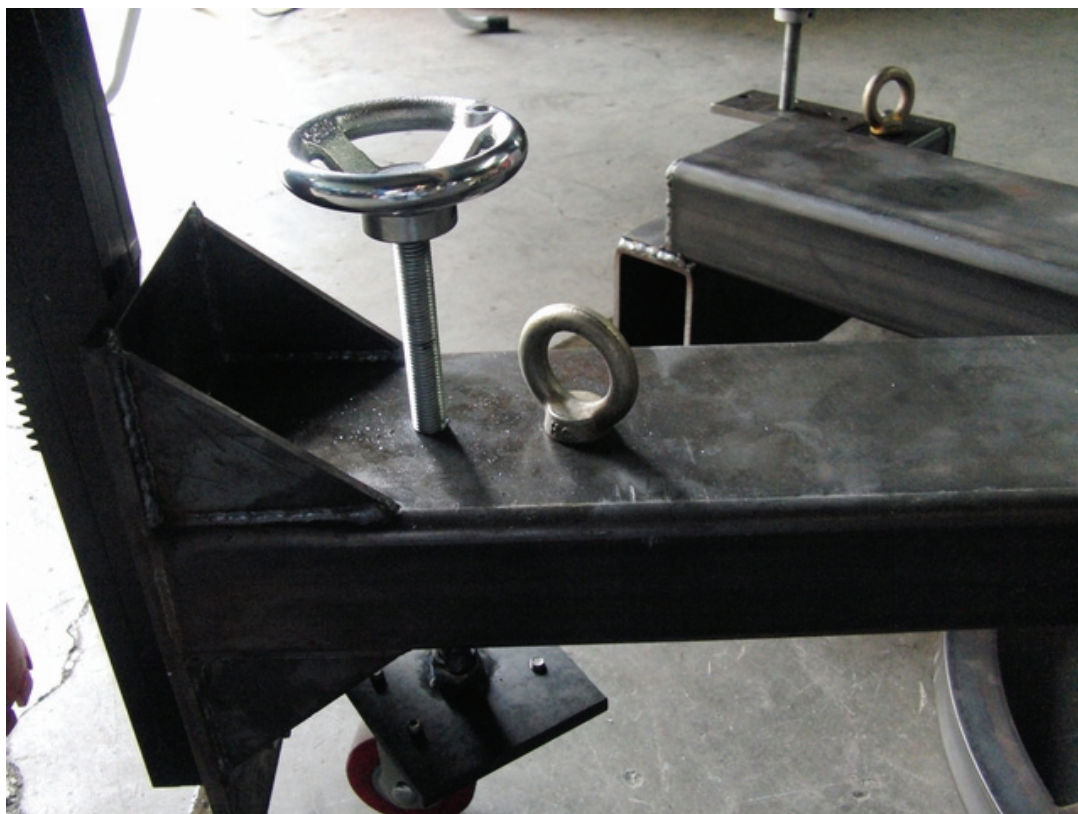
圖 4.32 位於鑽孔機側之輔助輪
