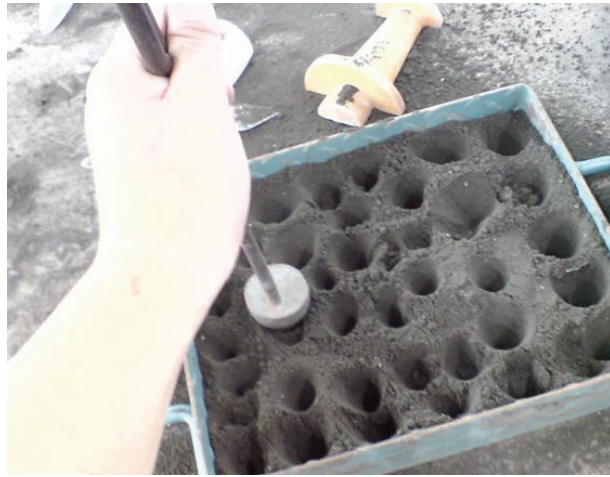
圖 4.14 鑄造砂模製作方式-以錐型頭鎚實讓砂與砂模之接觸更密實
