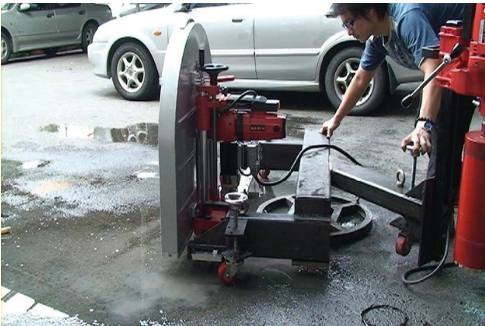
圖 4.45 操作人員以手動方式旋轉小面積鋪面挖掘修補機具雛形之實際作業情形
