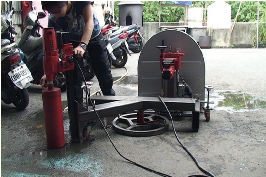
圖 4.38 操作人員以手動方式操作鑽孔機鑽孔之作業情形
