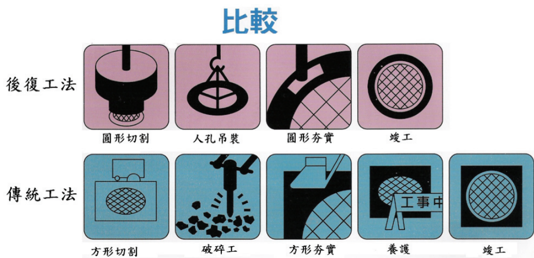
圖 2.6 後復工法與傳統工法之比較
