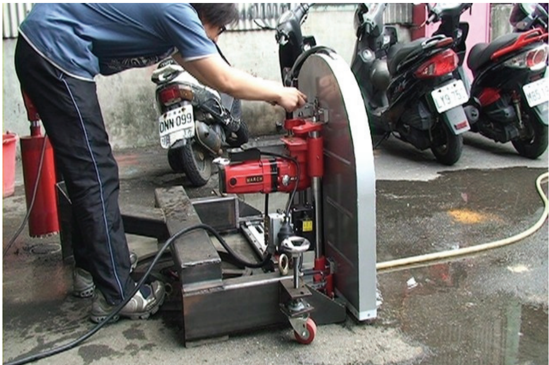
圖 4.41 操作人員以手動方式將鑽石鋸片推至所需之切割深度
