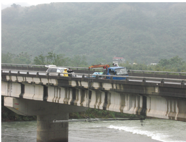
圖 4.19 橋檢車以低速向前行駛之動態檢測
