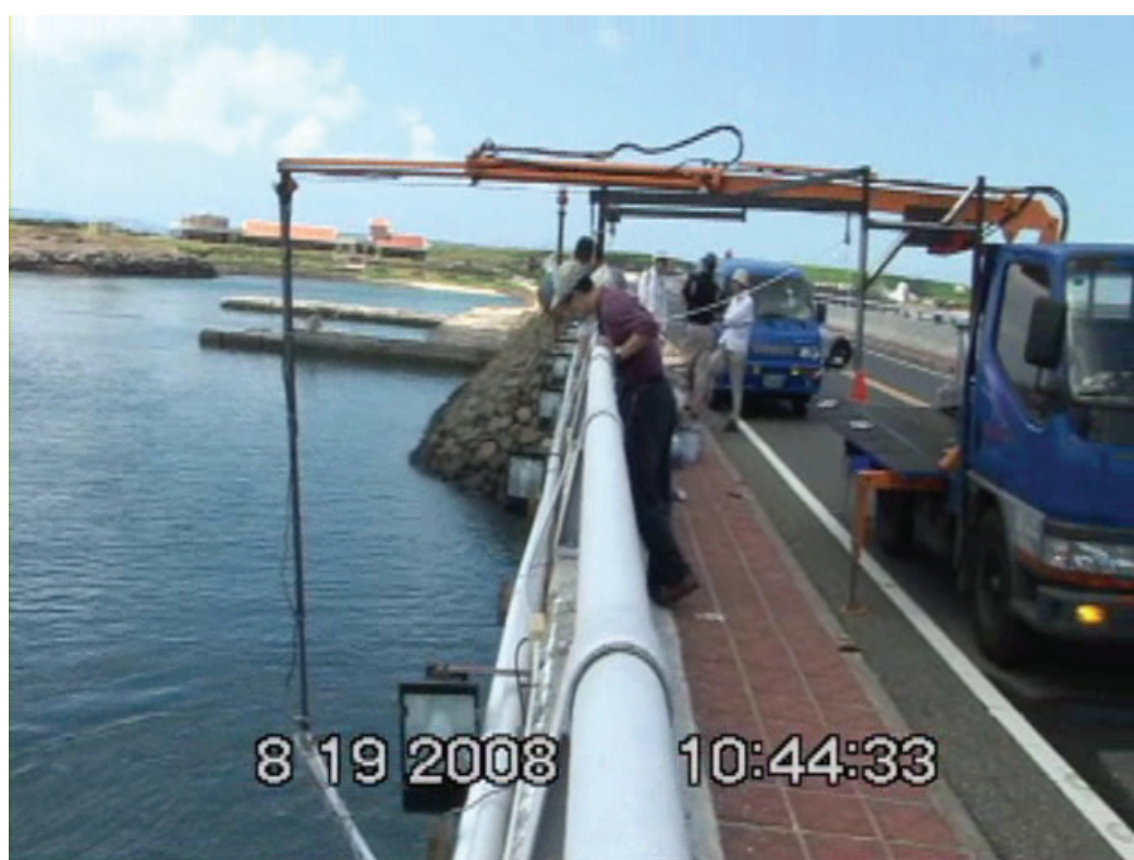
圖 2.25 橋檢車在澎湖跨海大橋實測之作業實況(1)
