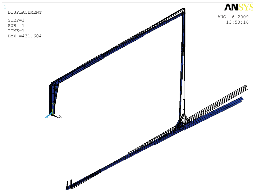
圖 3.25 第 2 階段設計之機械手臂考慮自重及承受負荷後形變狀況
