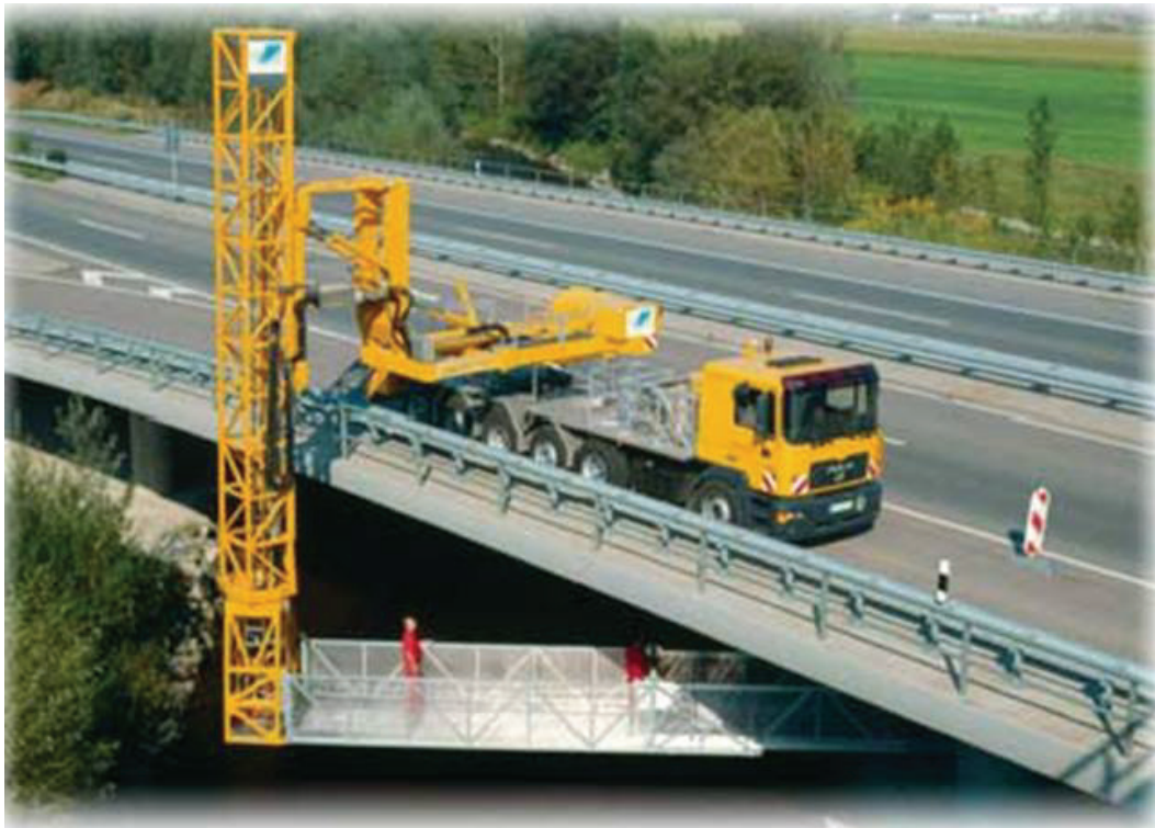
圖 2.7 MOOG 公司重型裝載設備之橋梁檢測實況之 1 [6]
