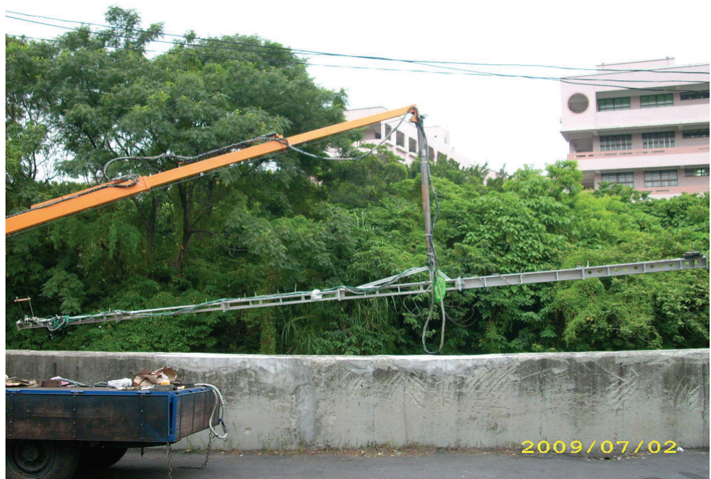
圖 3.18 第 2 階段設計之機械手臂組裝及操作測試
