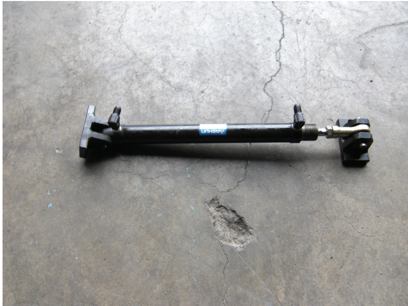
圖 7 第 4 臂油壓缸
