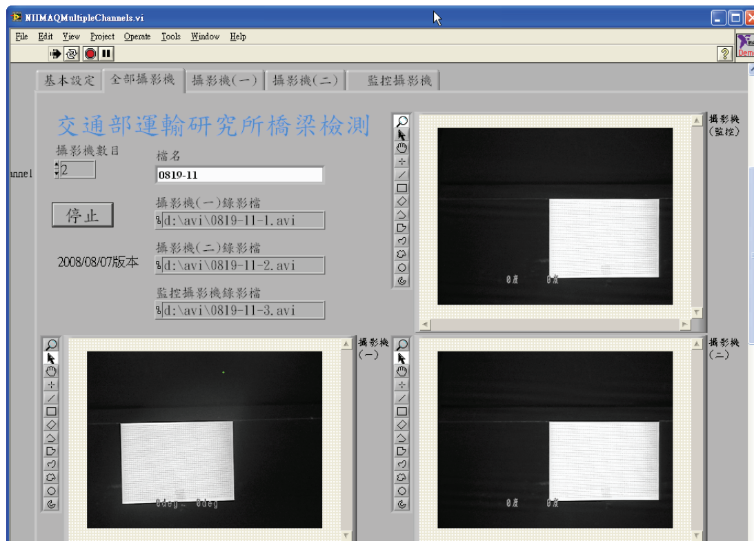
圖 3.11 CCD 影像面法向量與物件 A4 紙平面法向量兩者間夾角 0 度時所攝得之影像
