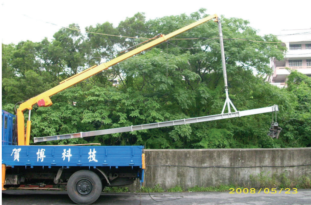
圖 2.24 橋檢車及機械手臂之實體車
