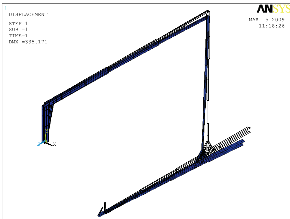
圖 3.21 第 1 階段設計之機械手臂考慮自重及承受負荷後形變狀況
