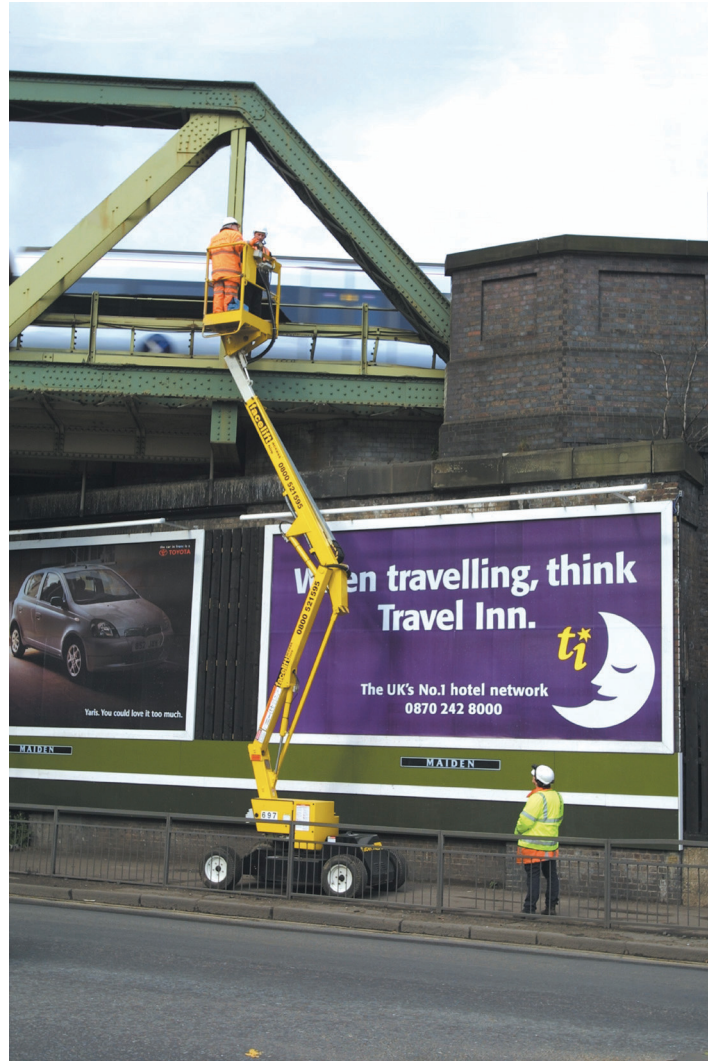
圖 2.9 Facelift, Inc.的橋梁檢測人員承載設備(Nifty height rider 120NBE) [8]
