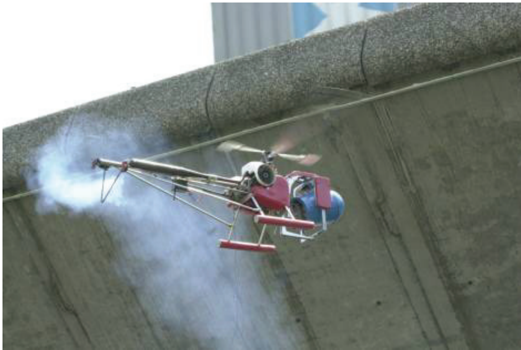
圖 2.11 Laboratoire Central des Ponts et Chaussées 之小型遙控直升機執行橋梁檢測 [10]
