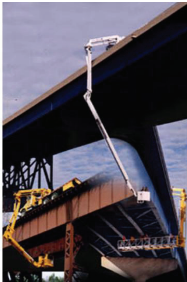
圖 2.3 Aspen Aerials 橋梁檢測車作業實況 [5]
