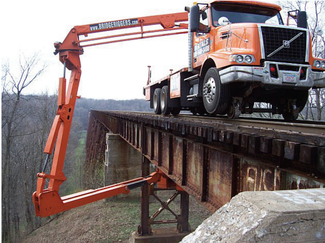
圖 2.5 N. E. Bridge Contractors, Inc.執行鐵路橋梁檢測 [7]
