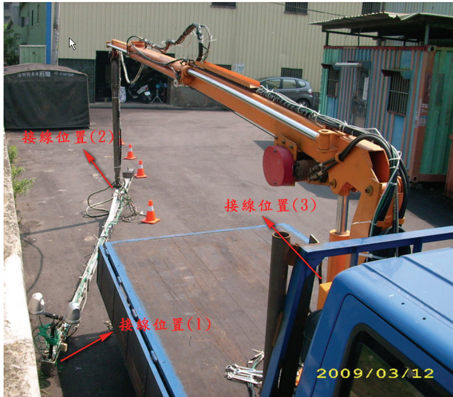
圖 26 機械手臂連接線位置
