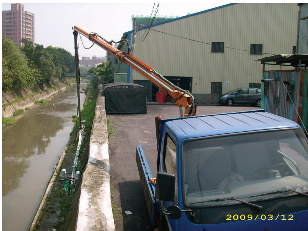
圖 3.17 第 1 階段設計之機械手臂組裝及操作測試
