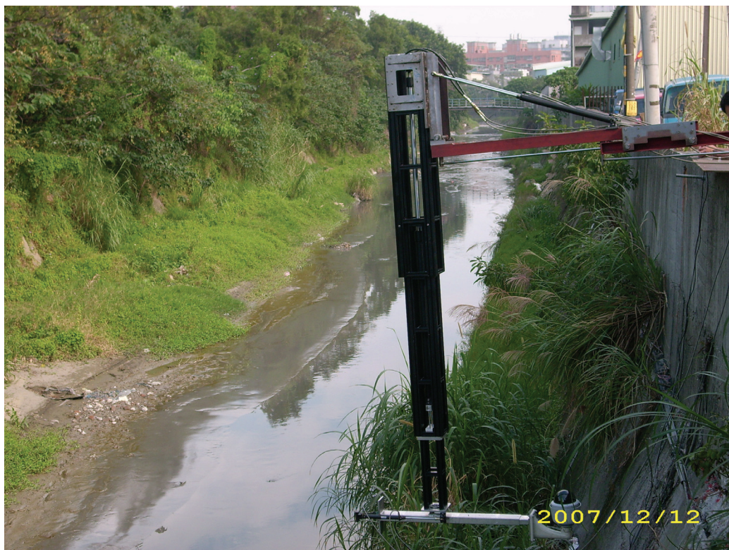
圖 2.21 橋梁檢測機械手臂室外測試
