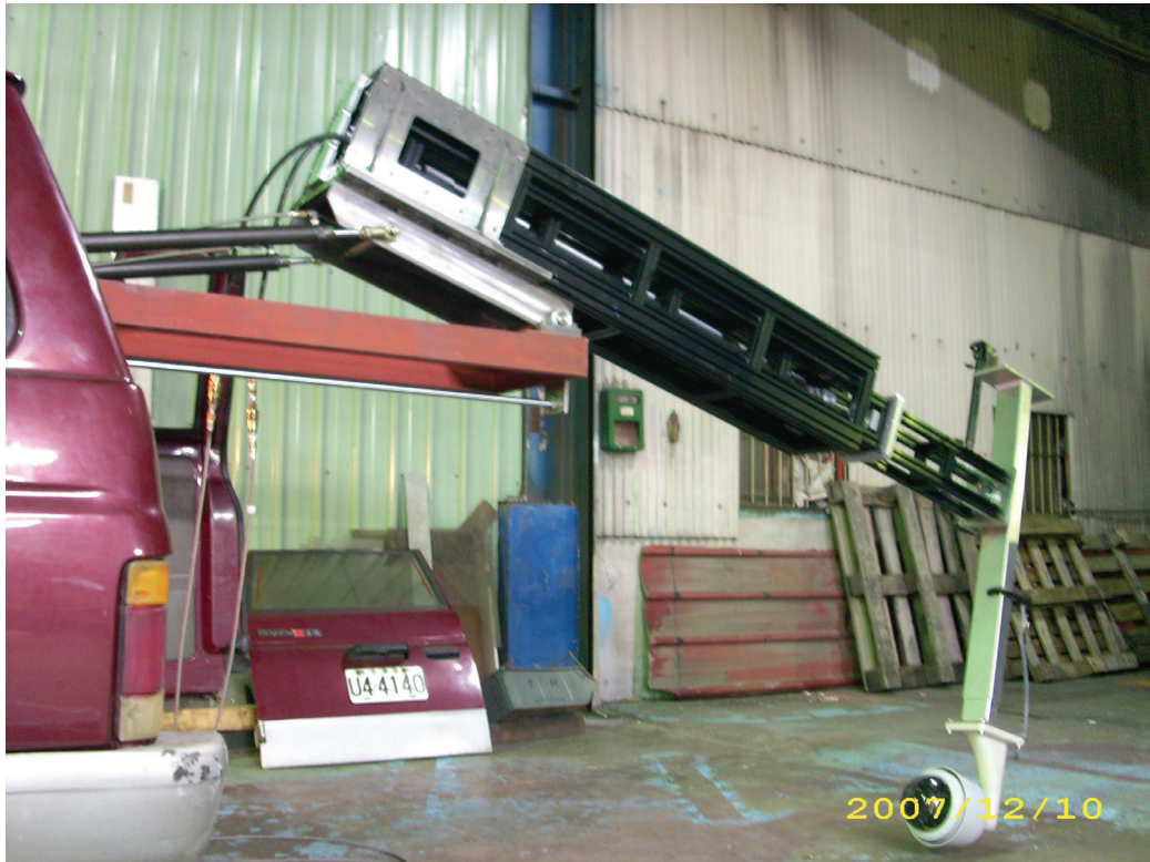
圖 2.19 機械手臂組裝後油壓推進測試
