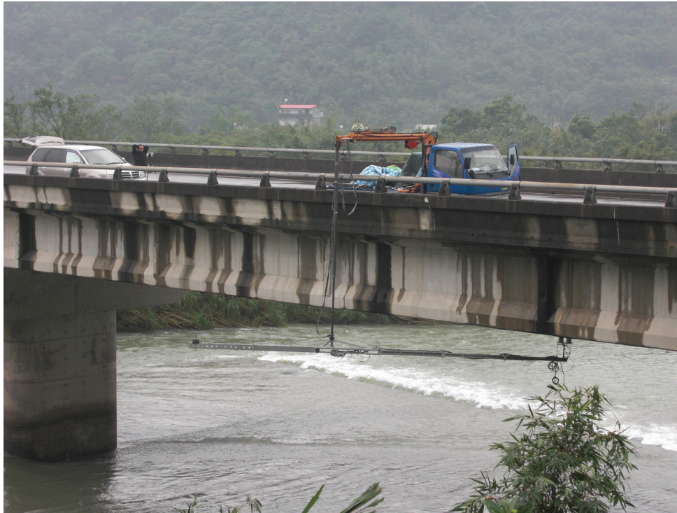
圖 3.48 負載力矩與平衡力矩之實際平衡狀況測試
