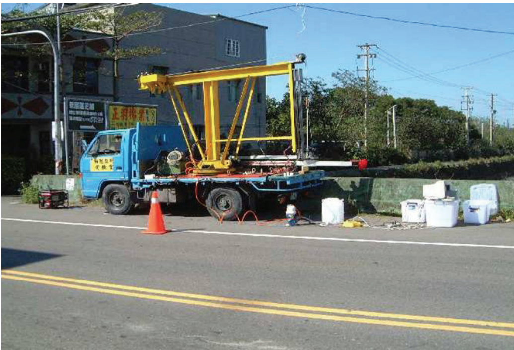
圖 2.16 橋檢車在富練橋實測之準備作業狀況
