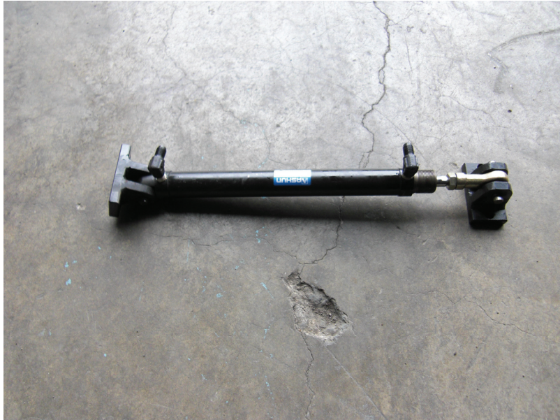
圖 3.14 新設計所增加之油壓缸(第 4 臂)
