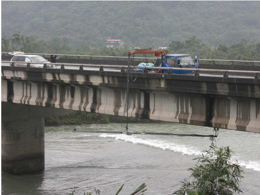
圖 4.18 第 3 臂到達檢測位置
