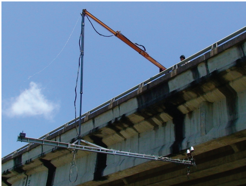
圖 11 機械手臂組裝後實測操作
