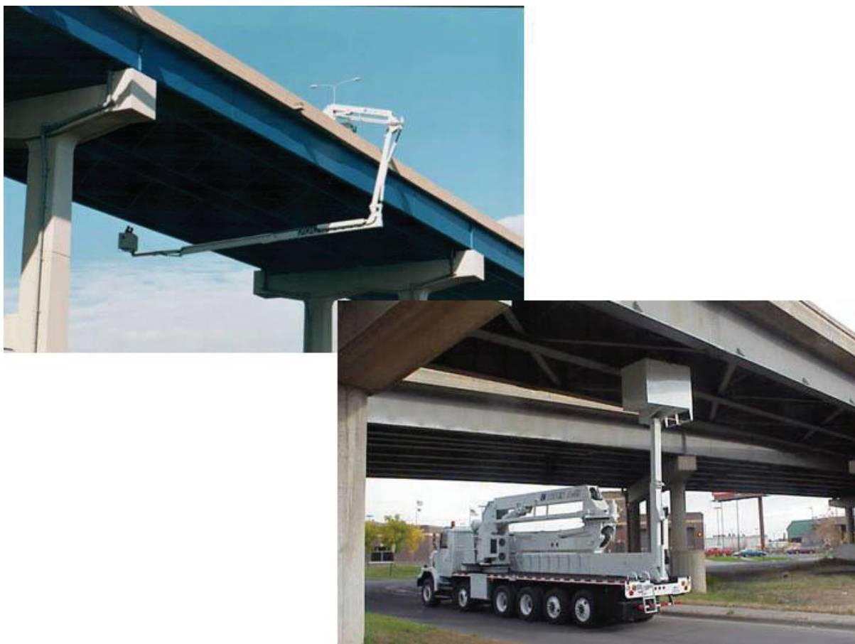
圖 2.4 Aspen Aerials 最大的橋梁檢測作業平臺 A-75 [5]
