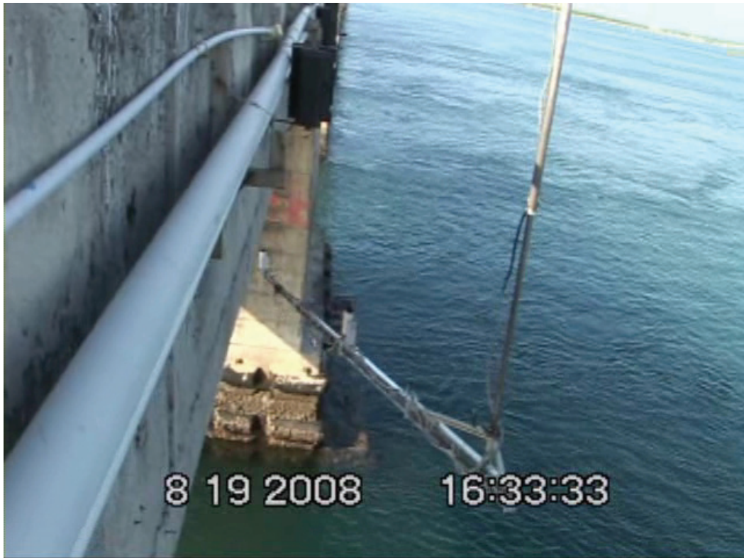
圖 2.26 橋檢車在澎湖跨海大橋實測之作業實況(2)
