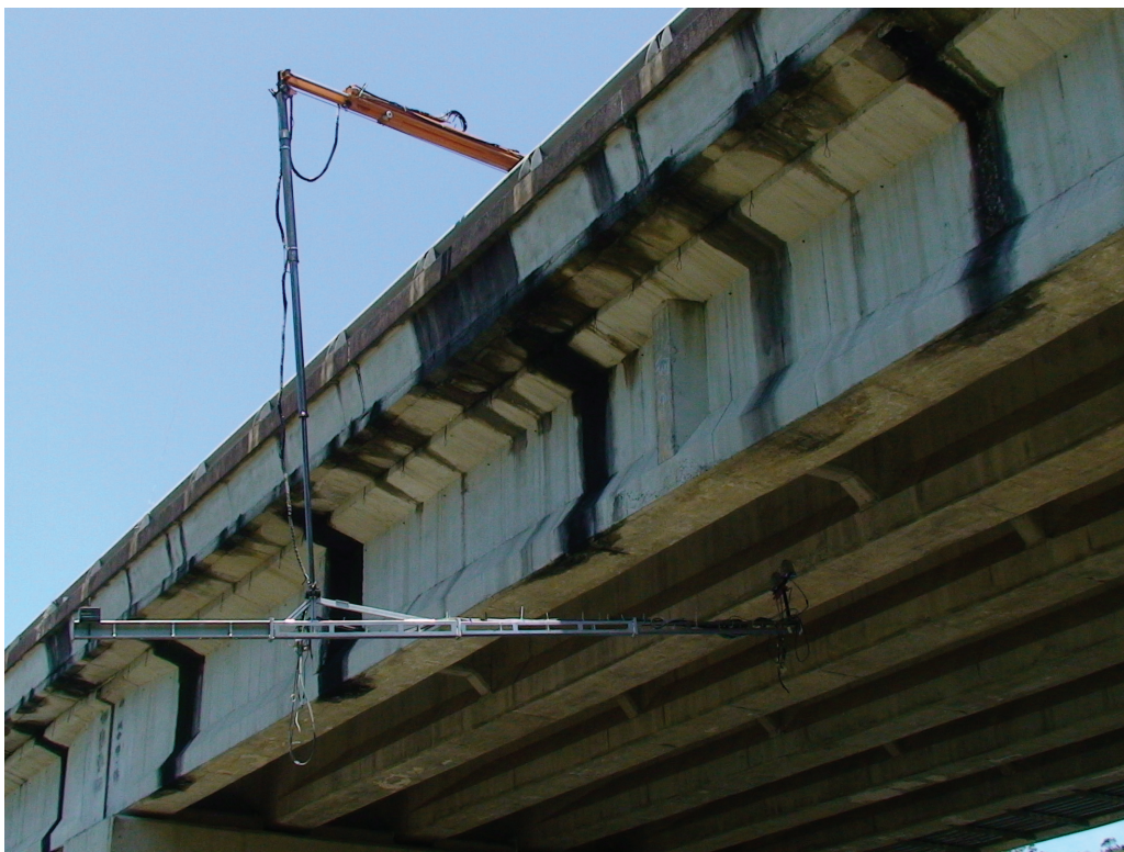
圖 4.5 收回第 1 臂將攝影機由橋外緣向橋中心移動
