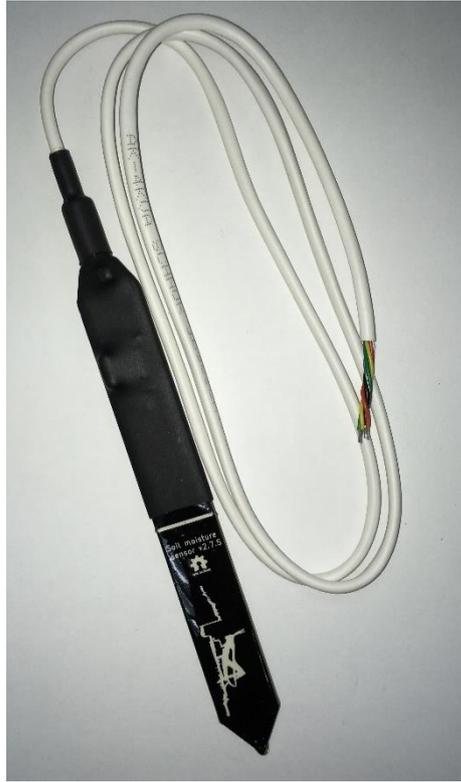
圖 3.2 電容式土壤水份計
