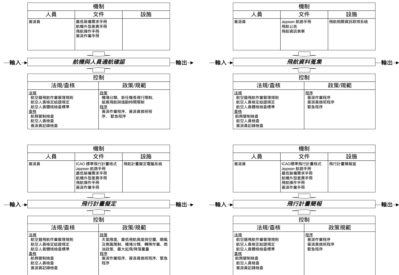
圖 5.6 航機飛行前準備階段中飛航資訊活動之「機制」與「控制」要素
