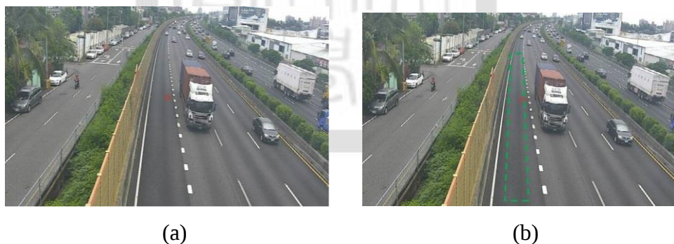
(a) 設定靜態背景及設定偵測區域；(b) 偵測區域內之影像空間密度(%)
