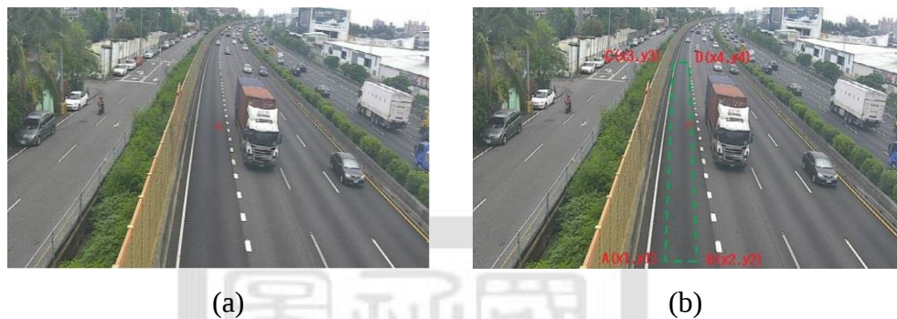
(a) 設定靜態背景及設定偵測區域；(b) 偵測區域內之影像空間密度(%)
