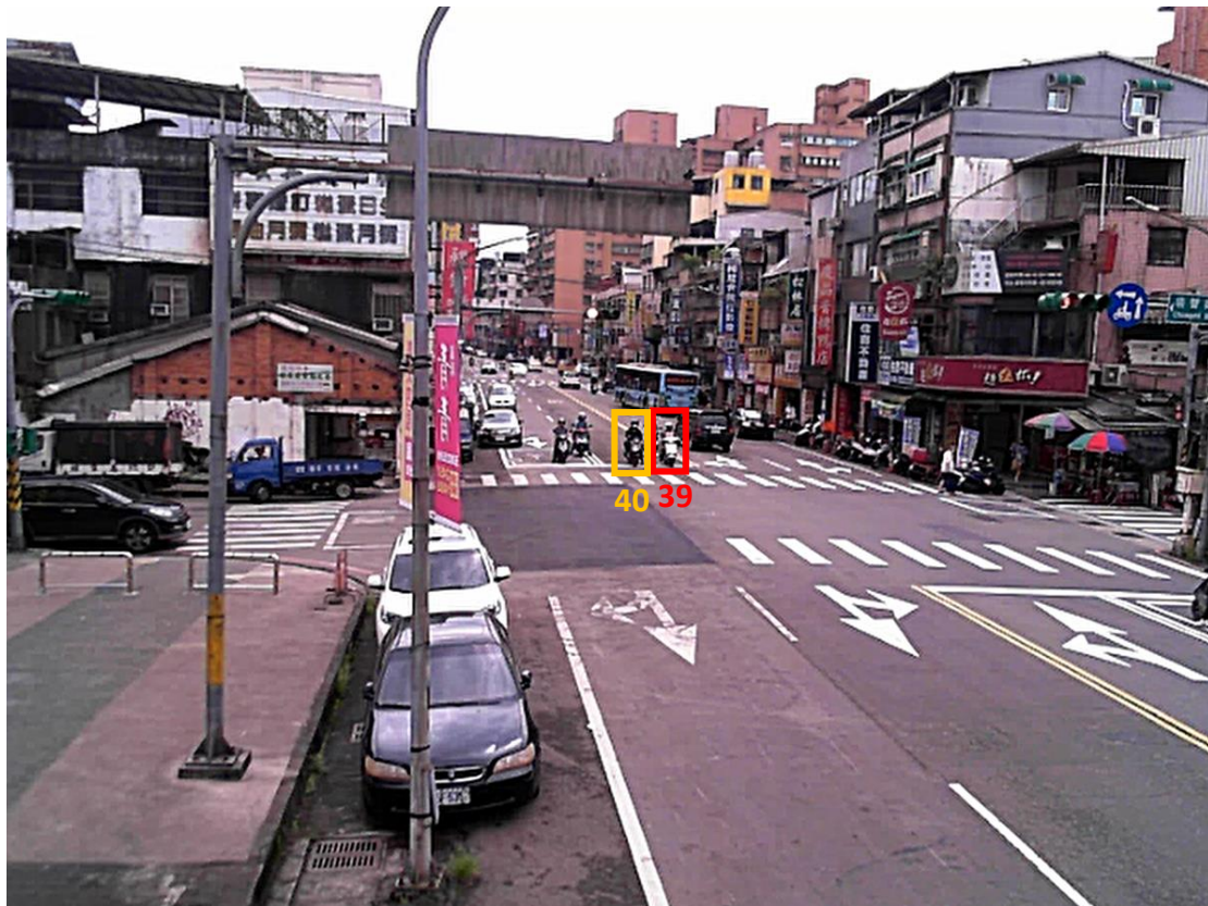
圖 4.3.3 影像資料—雷達與停止線距離
