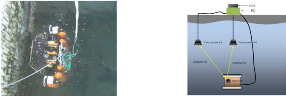
圖 1 碼頭設施巡檢及聲納定位(Shin et al., 2014)
