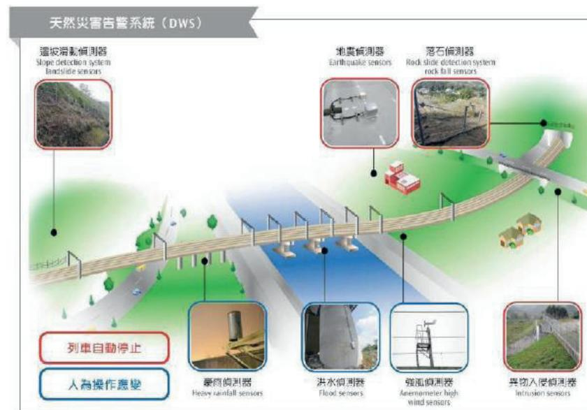
圖 2.4 高鐵天然災害告警系統示意圖
