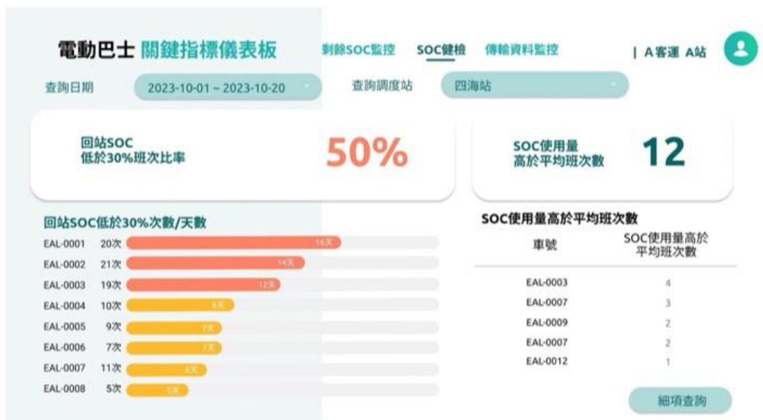
圖 4.4.3 能耗資料分析應用方向-SOC 健檢儀表板(示意圖)
