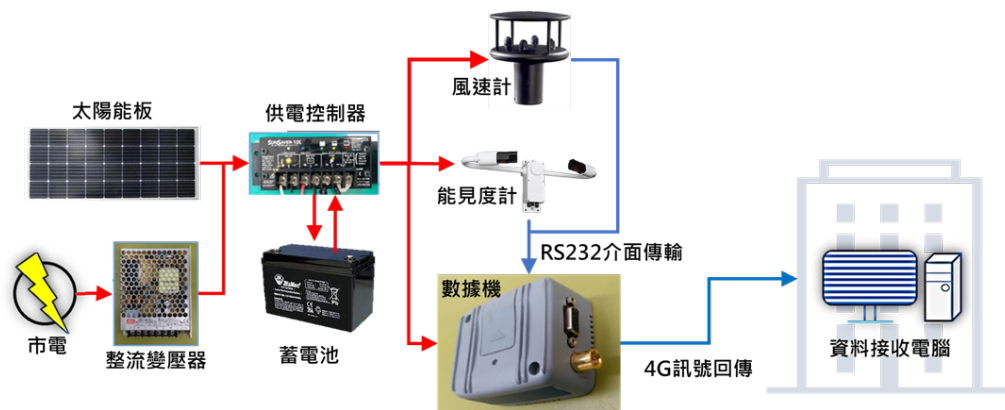
圖 2.1 風力及能見度測站系統架構圖
