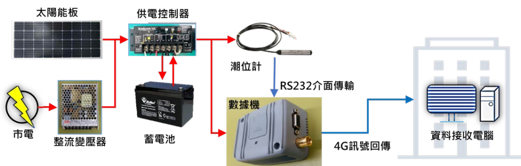
圖 2.2 潮位及靜穩度測站系統架構圖
