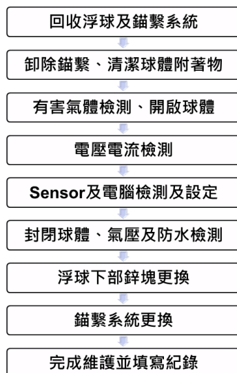
圖 2.12 浮球式波流測站檢查流程圖與常見問題
