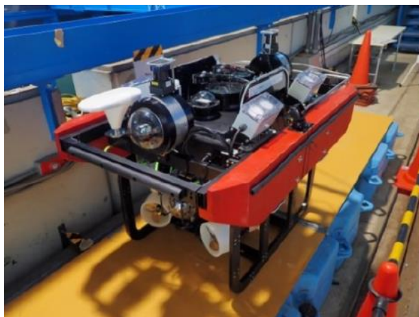
圖 4.7 棧橋底板巡檢用 ROV [7]
