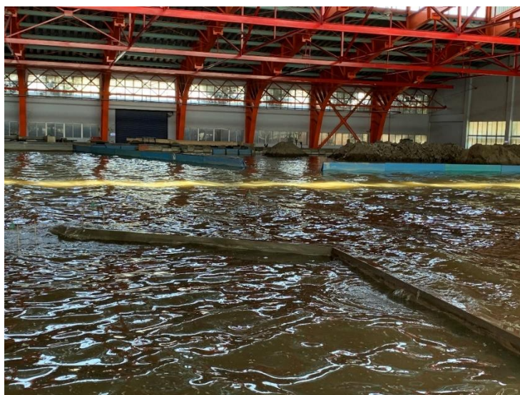
圖 10 冬季波浪沿北外廓堤頭及堤面越波照片
