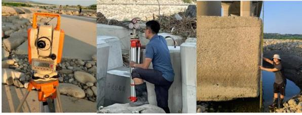
圖 19 控制測量作業情形
