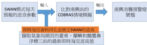
圖 2 海岸公路浪襲預警系統預警資訊修正後的流程
