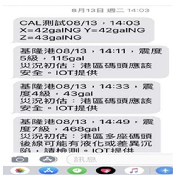
圖 4 震災分級發送速報簡訊與測試
