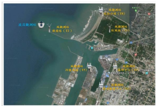
圖2 海氣象觀測站儀器安裝位置示意圖
