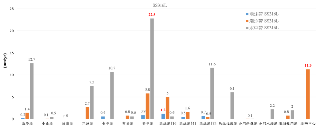
圖 9 各港區第一年不銹鋼金屬水下腐蝕速率分析
