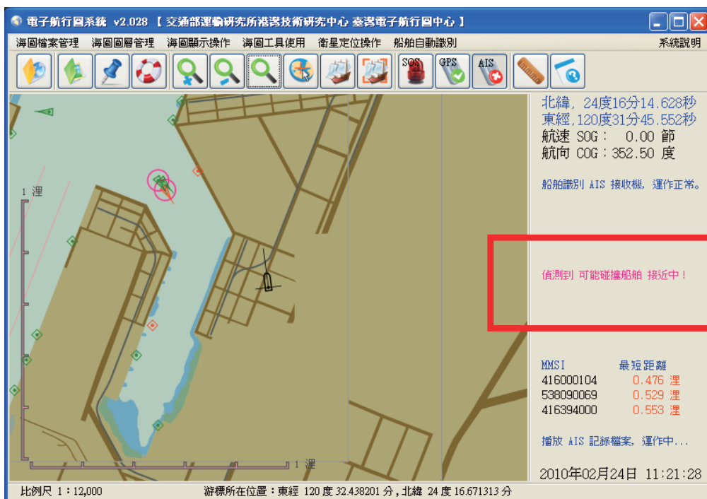
圖 19 安全警告設定：偵測可能碰撞船舶 (CPA、TCPA)
