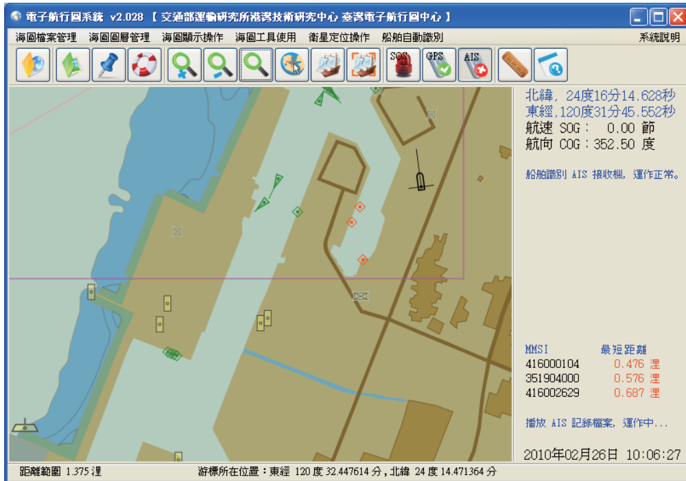
圖 14 顯示鄰近船舶相關資訊(MMSI 與距離)
