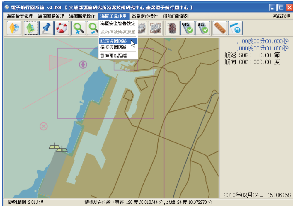
圖 20 安全警告設定：設定海圖航路
