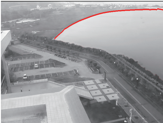
圖9 疊代600次之輪廓曲線 (西子灣平均影像,方位角1000, 2010/05/01, 06:00 a.m.)
