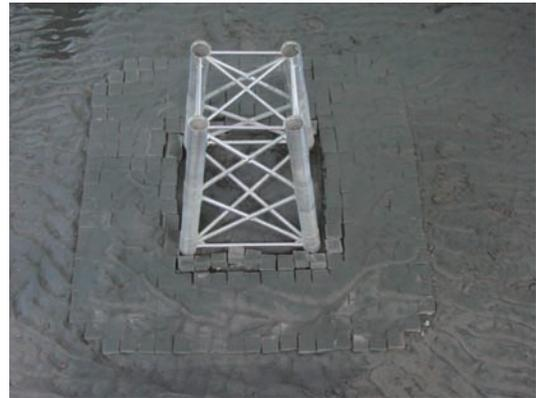
照片7 16TLLCPM試次造波後保護工安定與地形變化情形
