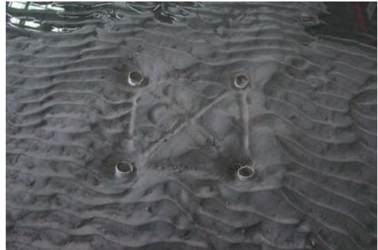
照片3 16TLLCM試次造波後地形變化情形
