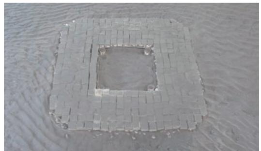
照片6 12TLLCPM試次造波後保護工安定與地形變化情形
