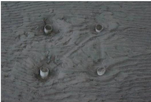
照片4 12SLLCM試次造波後地形變化情形
