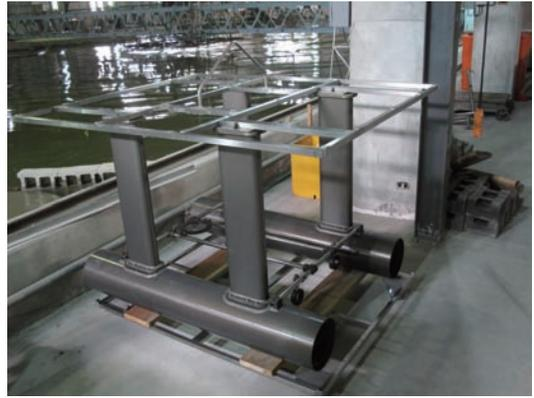
圖7 SWATH船型實驗船
