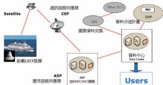
圖4 船舶遠距識別與追蹤系統功能說明
