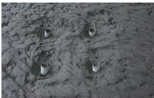
照片2 12TLLCM試次造波後地形變化情形
