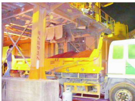
圖 9 彩色瀝青混合料卸料情形
