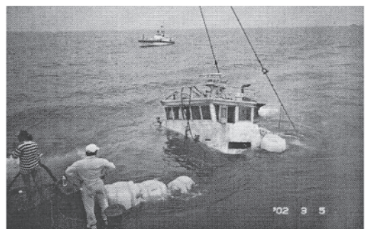
圖十七 將便民輪固定在吊桿船船舷邊
