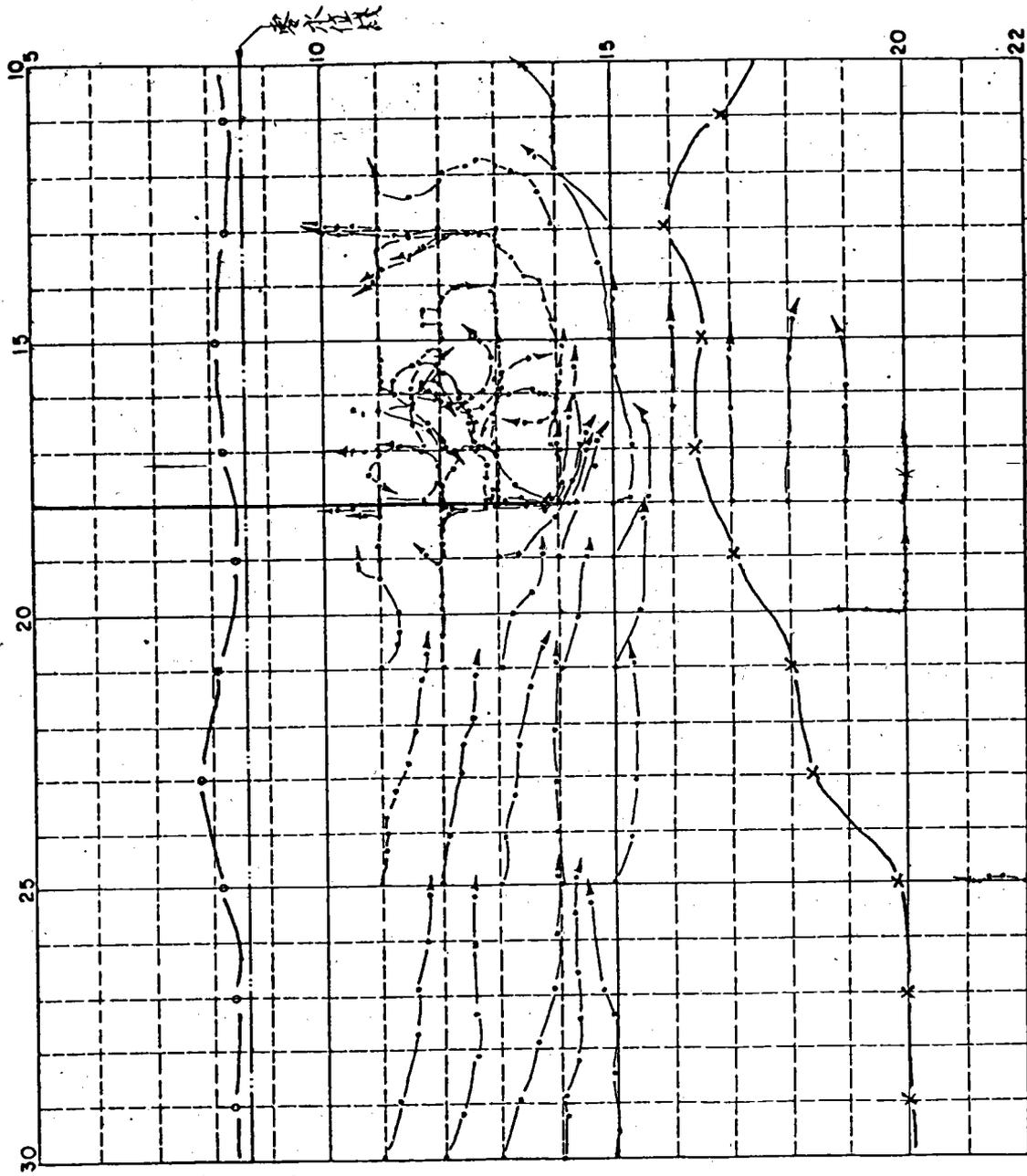
圖 6-62 台中海岸流況模型試驗記錄紙
