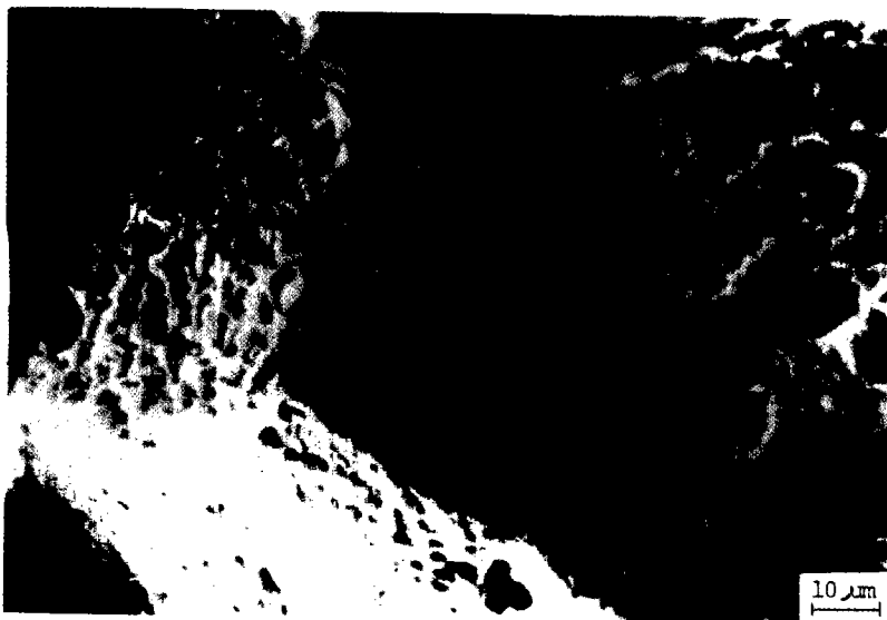
圖 6：粒間窩式斷裂，在晶界表面有窩坑之形成。( 1340 : 1. )
