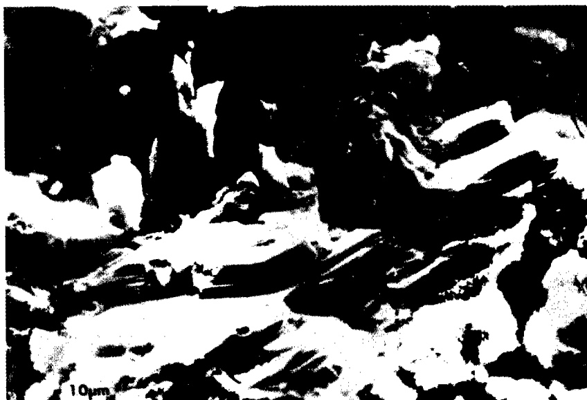
圖九 水化的矽酸三鈣水化物沿氫氧化鈣節理拆裂面之 S E M 微觀圖〔 7 〕
