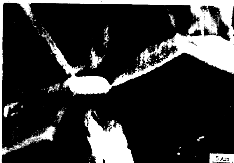
圖 12 碳鋼在 80°C 含有 34.7 % 之 \text{Ca}(\text{NO}_3)_2 之水溶液中的粒間應力腐蝕破壞。
