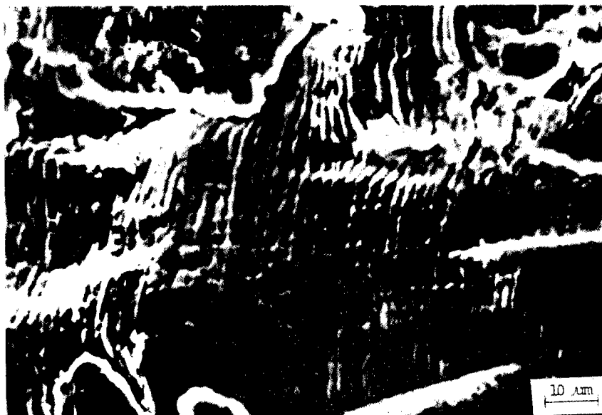
圖 8：疲勞破裂典型疲勞紋。
