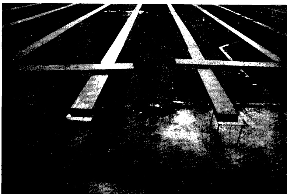
照片 9-f 佈置 B 颶風 S 向波浪造波9小時後，東防波堤外側沿岸變化地形
