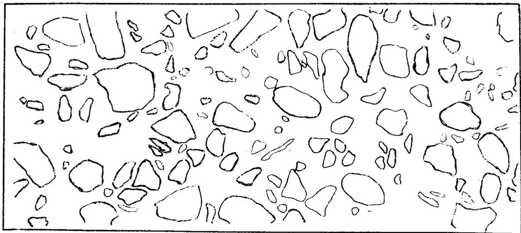
圖 4-6 鑽心試體外觀骨材分佈描繪圖(續)，(沉箱編號 SB-8)
