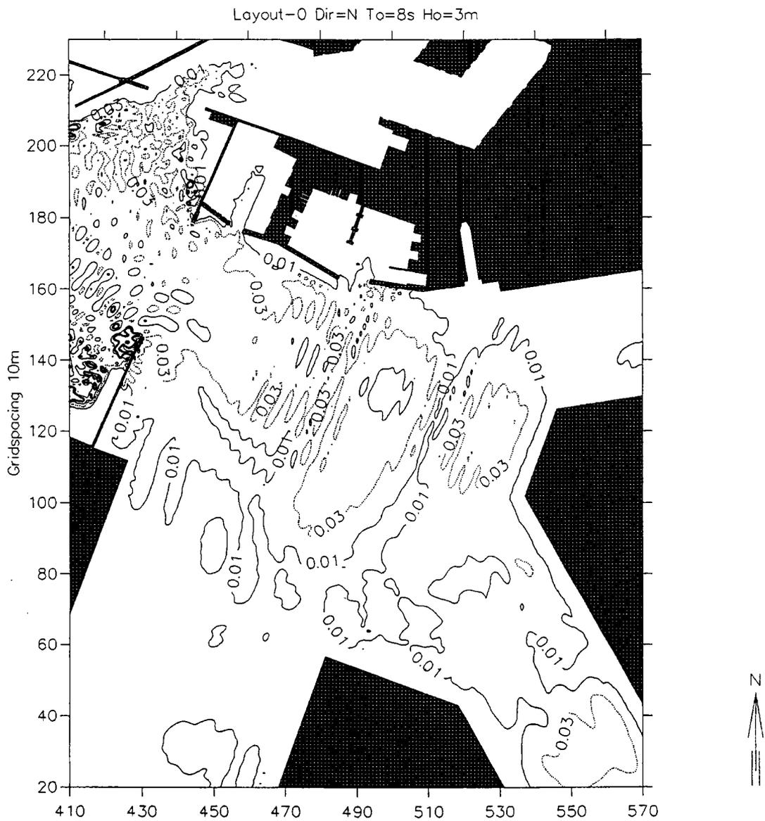
圖 3-3-1f 現況佈置波高遮蔽係數  $K_d$ (測點波高/入射波高)等值線圖
