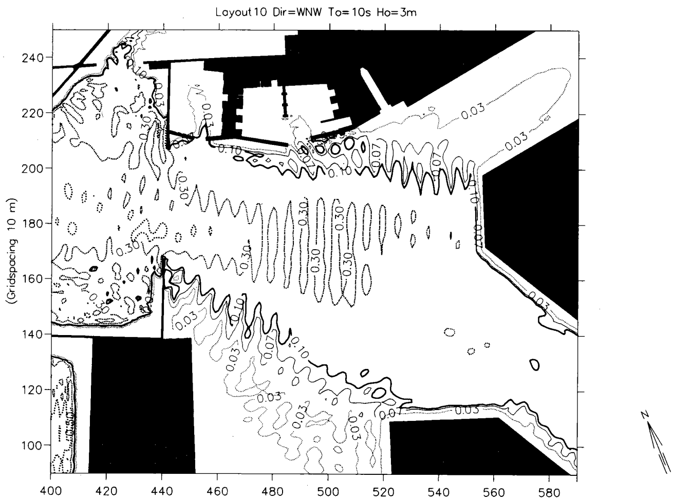
圖 4-9-2a 台中港港口二期擴建替選方案X港內水域計算之波高 遮蔽係數 K_d 圖 (入射波向：WNW；週期：10 秒；波高：3 公尺)
