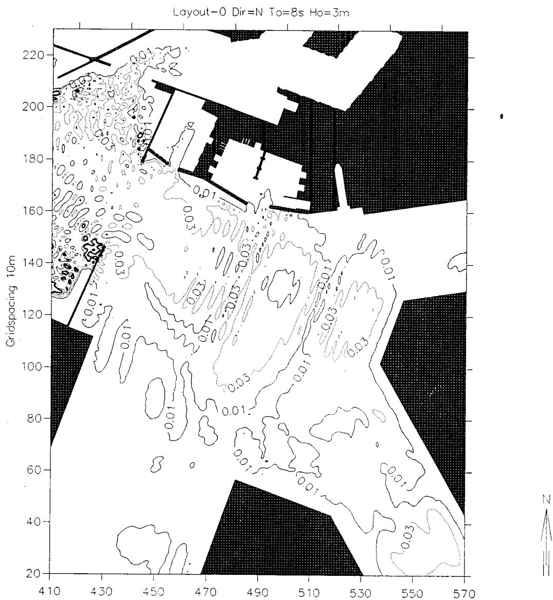
圖 4-5-0a 台中港港口二期擴建現況配置港內水域計算之波高 遮蔽係數 K_d 圖 (入射波向：N；週期：8 秒；波高：3 公尺)
