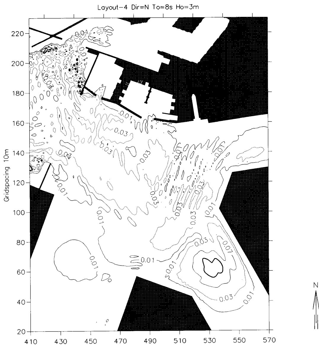
圖 4-5-4a 台中港港口二期擴建替選方案IV港內水域計算之波高 遮蔽係數 K_d 圖 (入射波向：N；週期：8 秒；波高：3 公尺)
