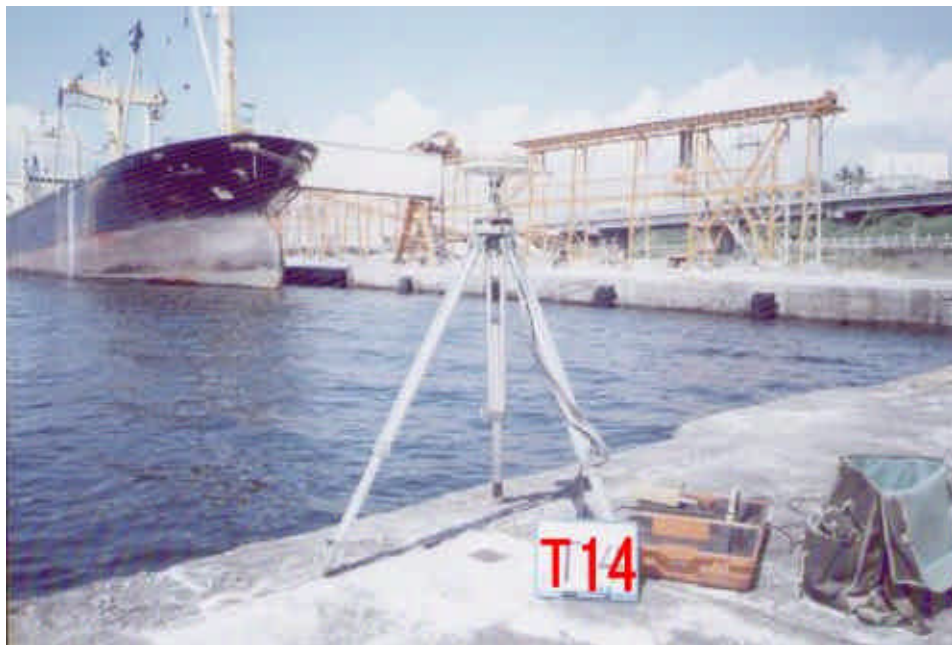
圖 15 測量控制點 T14 檢測
