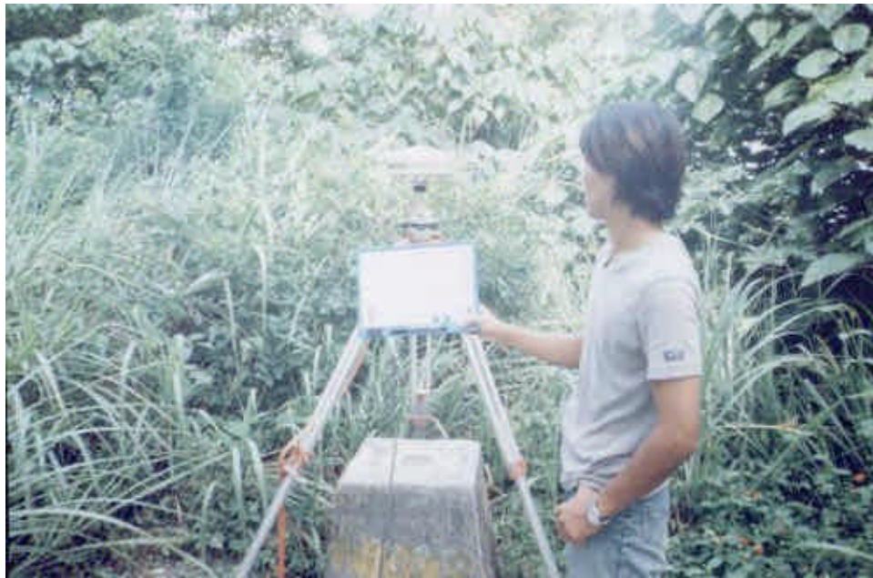
圖 13 測量三角控制點美崙山 E008 檢測
