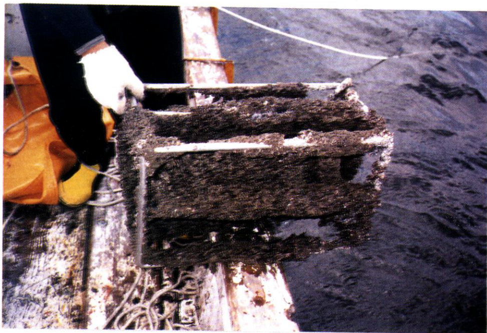
圖 2-9 觀測儀器上生物附著情形。
