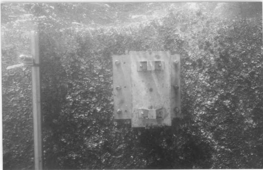
圖 3.1.2 沉箱壁波壓計感應器及容量式波高計固定架
