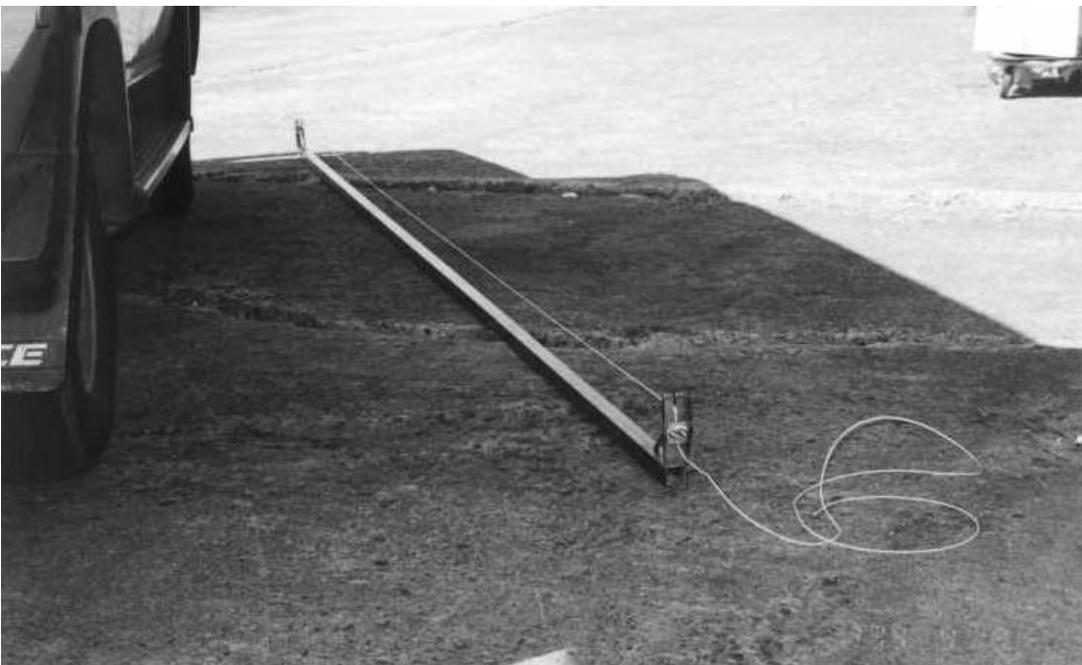
圖 3.1.3 沉箱壁容量式波高計
