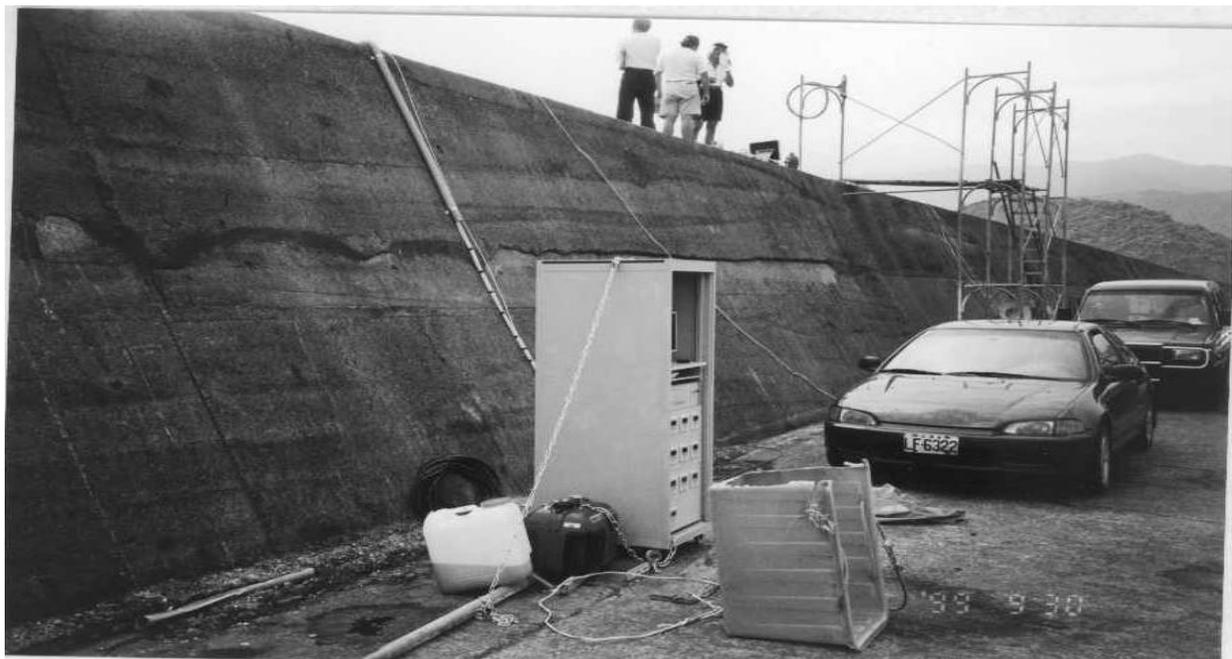
圖 3.1.4 沉箱壁波壓計及容量式波高計之資料擷取系統
