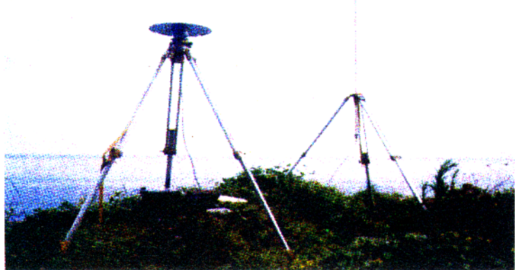
圖 2-3-2 岸上基地台 GPS 天線盤及無線電天線
