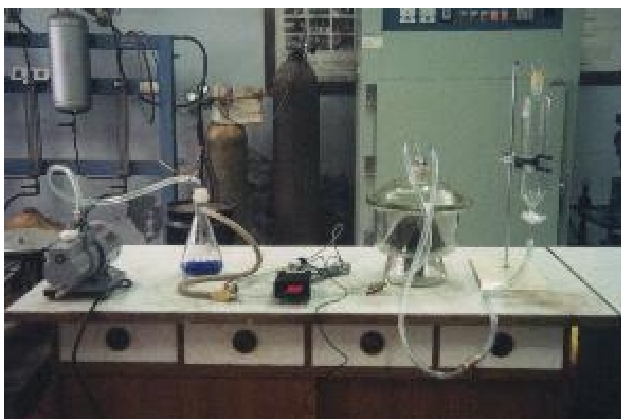
照片 3.7 電滲試驗儀器(一)-試體前處理
