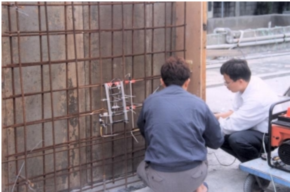
照片 3.3 試驗牆 Sensor 埋設情形
