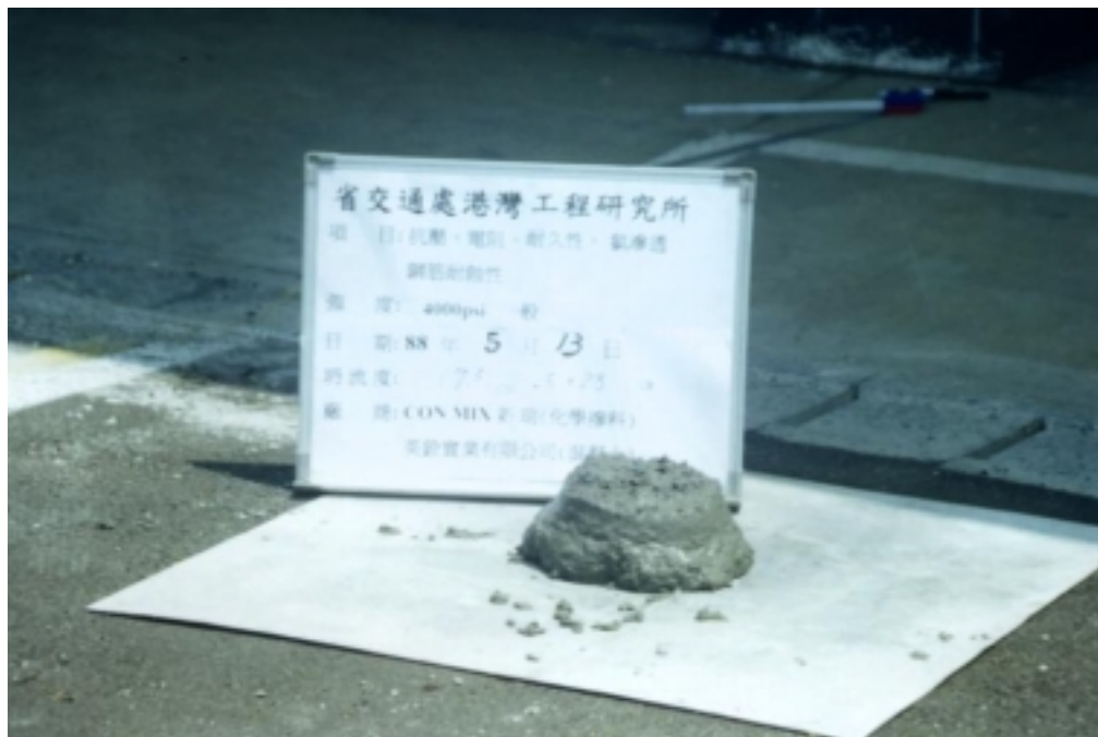
照片 4.2 配比 B OPC-4000psi 之坍度及坍流度
