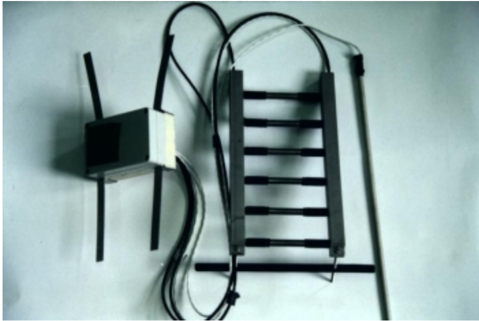
照片 3.14 Anode-Ladder-System 腐蝕監視系統
