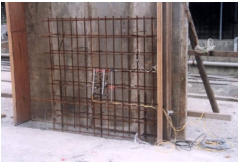
照片 3.2 單座試驗牆之實際佈置情形
