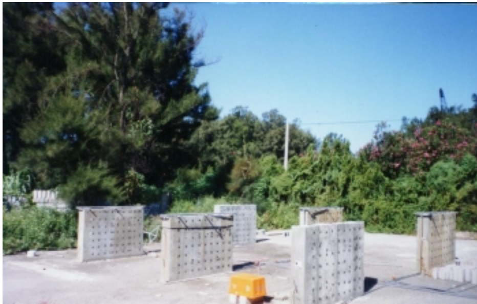
照片 3.5 六面試驗牆之實際曝露試驗位置圖
