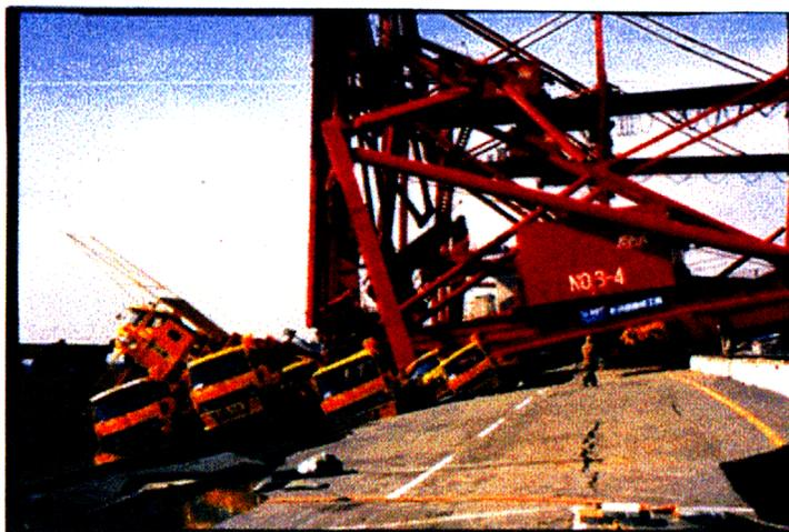
照片 2.5 Rokko Island，因液化沉陷引致之吊車結構破壞
