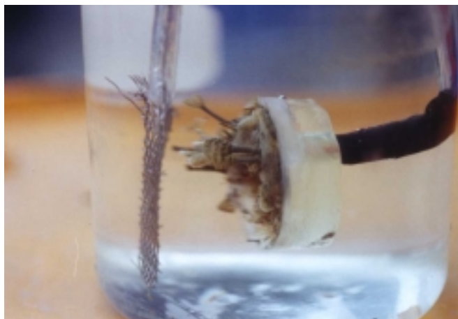
照片 4.7 試片浸漬時間 55 天（表面海生物呈垂直分布）
