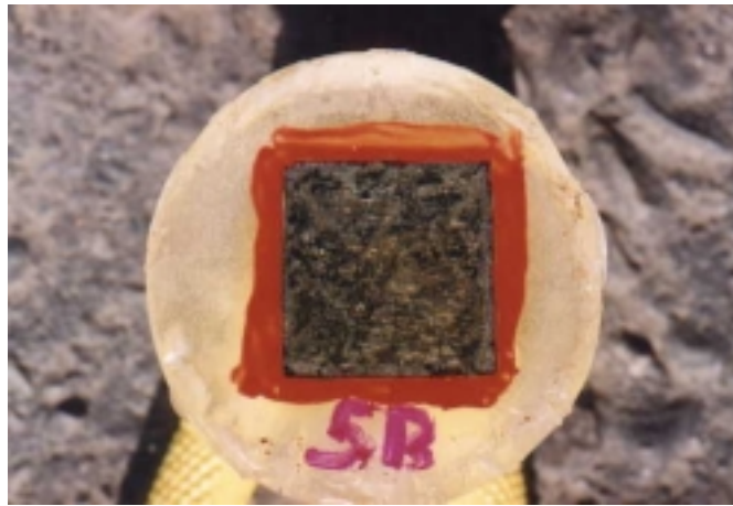
照片 4.11 試片浸漬時間 5 天（刮除海生物後）
