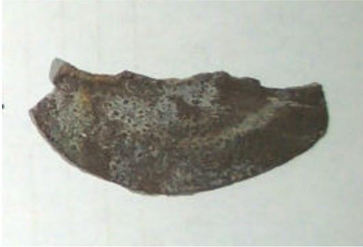
相片 19. A 型塗料與鋼樁接觸面
