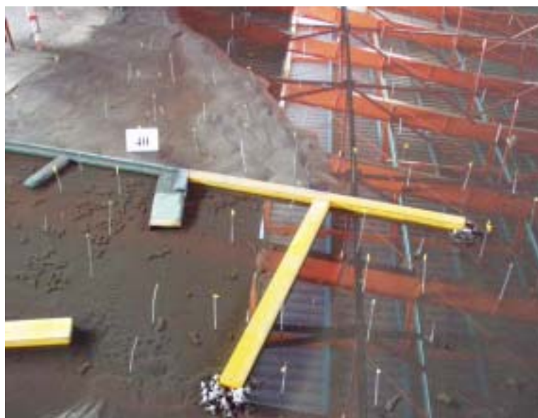
照片 4-3 改善配置 D 試驗造波 40 小時後的模型試驗照片
