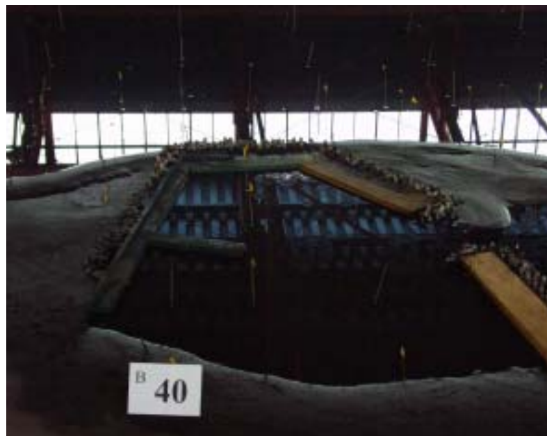
照片 3-2 主配置 B 試驗造波 40 小時後的模型試驗照片
