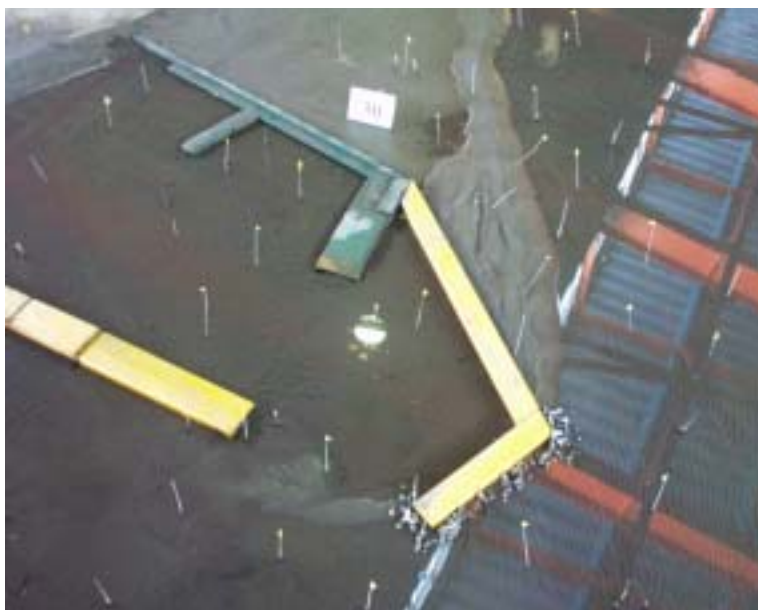
照片 4-1 改善配置 C 試驗造波 30 小時後的模型試驗照片
