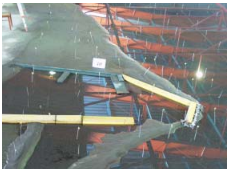
照片 4-2 改善配置 C 試驗造波 40 小時後的模型試驗照片
