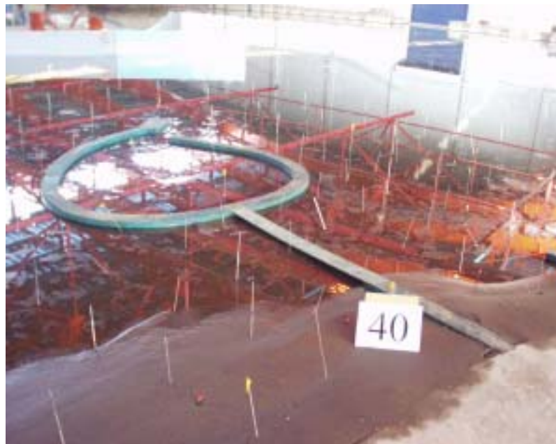
照片 4-6 改善配置 F 試驗造波 40 小時後的模型試驗照片
