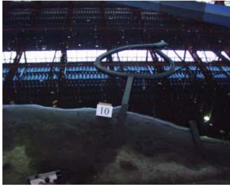
照片 4-5 改善配置 F 試驗造波 10 小時後的模型試驗照片
