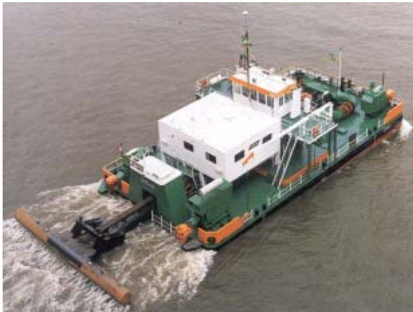
圖 3.2-11 噴水式挖泥船示意圖
