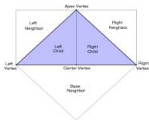
圖 6.7 基本鑽石型三角二元樹結構分割
