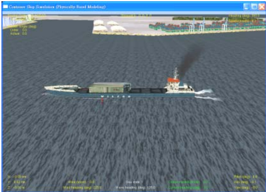
圖8.4 臺中港虛擬港灣模擬系統與國外學術研究單位公佈之船舶動力模式C++程式碼進行整合測試情形
