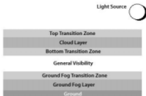
圖3.1 VEGA模擬系統中雲、霧的大氣模式
