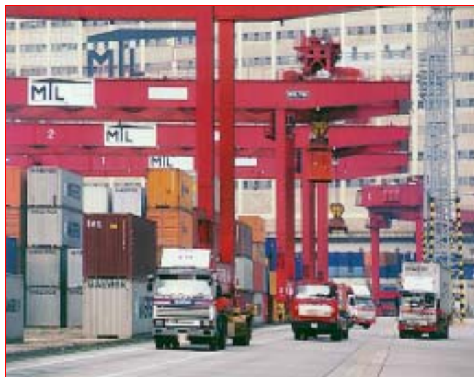
圖 3.1.4 軌道式門型起重機作業貨櫃場
