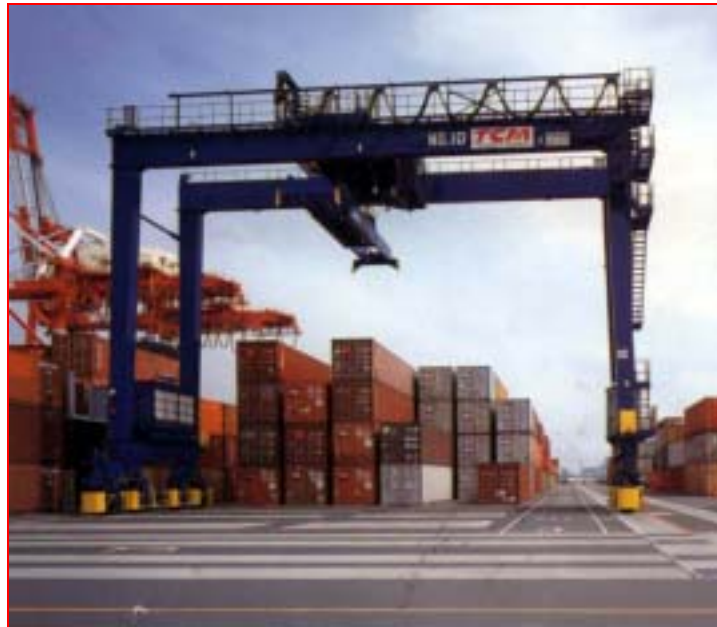
圖 3.1.3 輪胎式門型起重機作業貨櫃場
